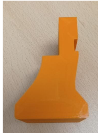
Figura 55. Impresión 3D del punzón final. Eje centrado en la dirección de la fuerza. Elaboración propia.
