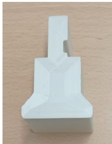
Figura 54. Impresión 3D del punzón final. Eje descentrado en la dirección de la fuerza. Elaboración propia.
