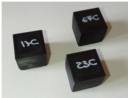
Figura 44. Probetas sin apenas deformación. Elaboración propia.
