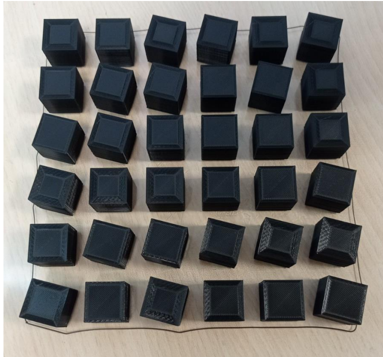
Figura 36. Impresión de probetas de altura de capa 0,15 mm. Elaboración propia.
