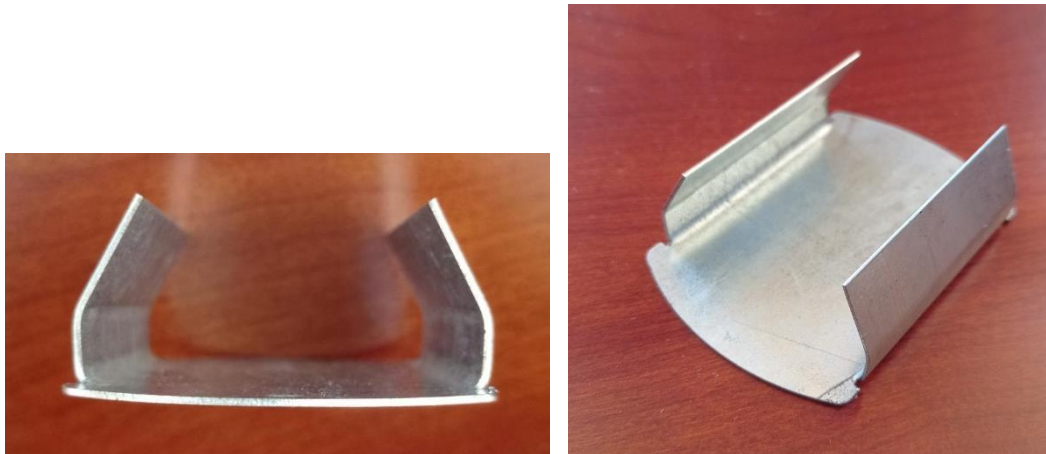
Figura 62. Resultado de la segunda prueba de doblado de la pieza deseada. Elaboración propia.
