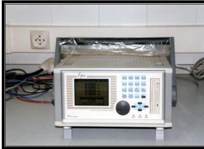
Figura 12.- Analizador de redes utilizado para los ensayos.
