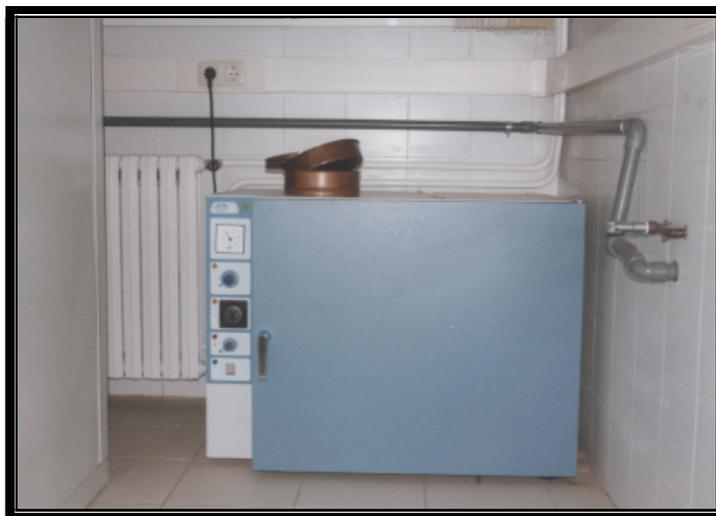
Figura 3.- Estufa utilizada para la determinación de la humedad de las muestras.
