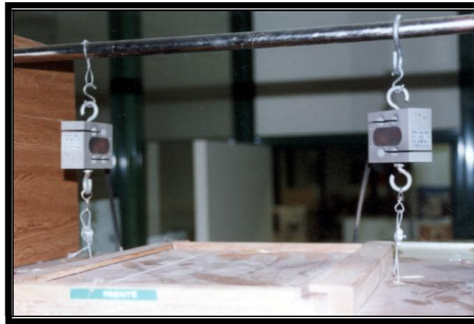
Figura 15.- Células de carga para medir la variación de peso durante el secado.
