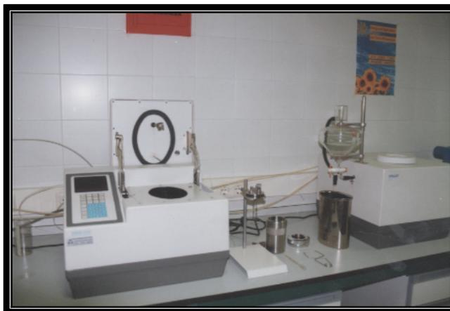
Figura 1.- Calorímetro isoperibólico utilizado para la determinación del poder calorífico.
