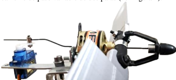
Figura 4: Perfil NACA 0012 y actuador del ángulo de pitch variable (gobernado por el servomotor)
