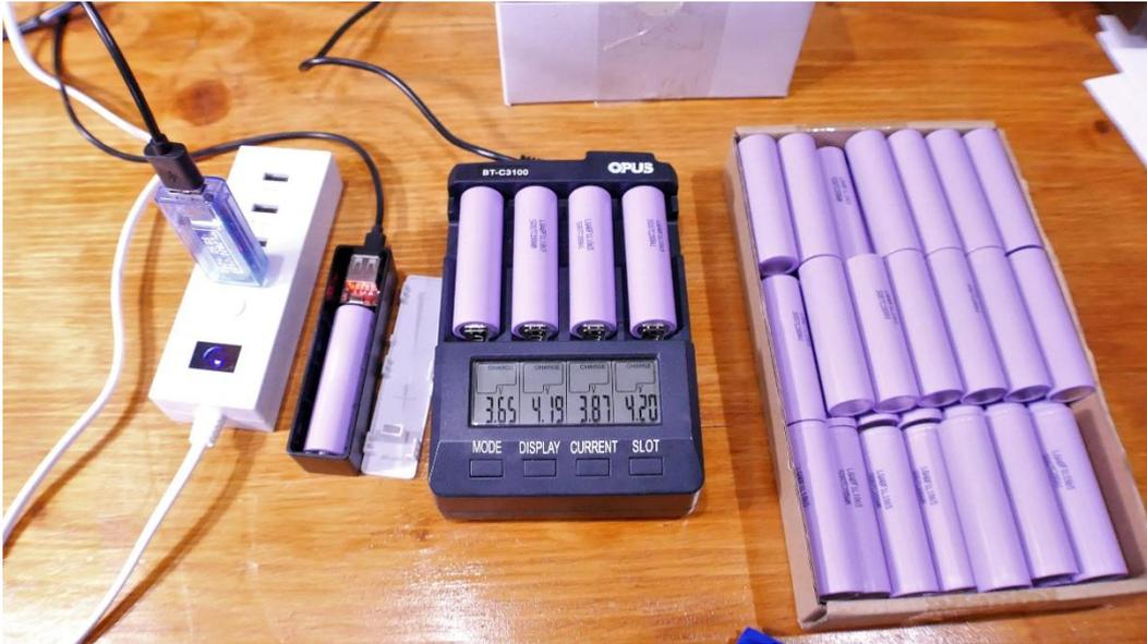
*Figura 3.21 Proceso de descarga de las celdas hasta la tensión máxima de 4.2V con el cargador OPUS BT-C3100 (Fuente: Elaboración propia).*
