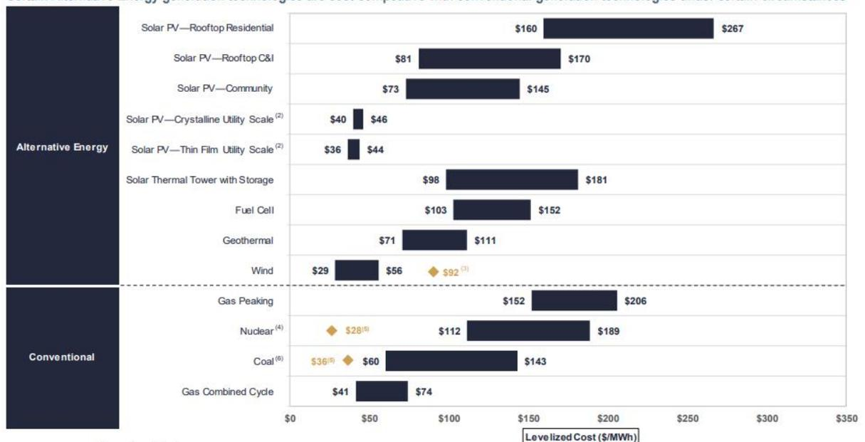
Figura 1.1 Comparación de costes de energía nivelados sin tener en cuenta subsidios. (Fuente: [1])
