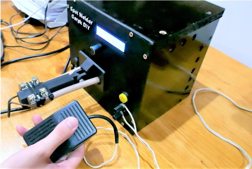
*Figura 3.84 Soldador por puntos ya finalizado (Fuente: Elaboración propia)*
