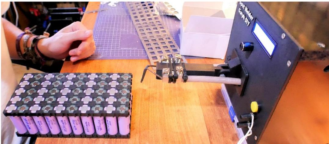
Figura 3.30 Celdas ensambladas entre los dos soportes plásticos (Fuente: Elaboración propia).
