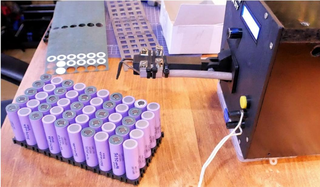
Figura 3.29 Celdas colocadas en el primer soporte plástico (Fuente: Elaboración propia).
