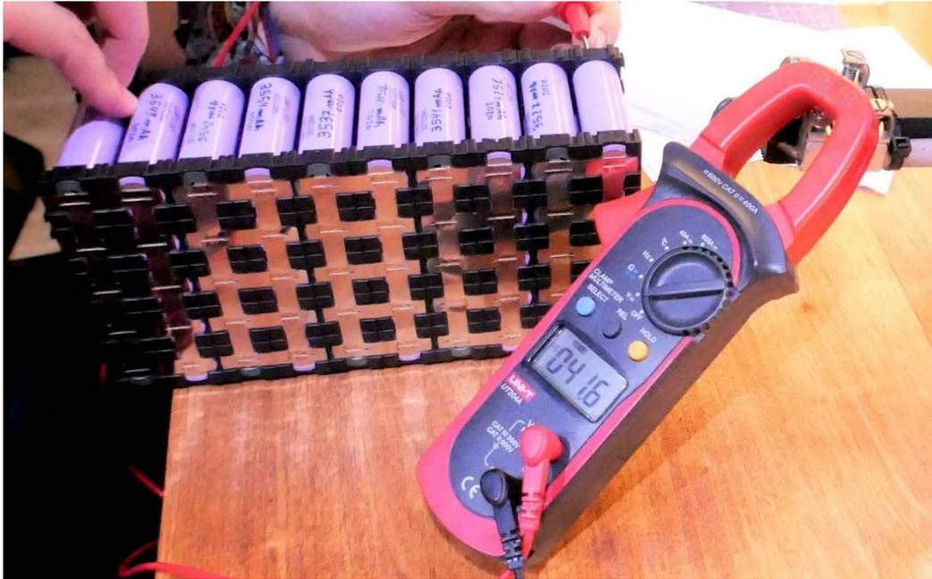
Figura 3.34 Comprobación con el multímetro de las tensiones del pack completo (Fuente: Elaboración propia).
