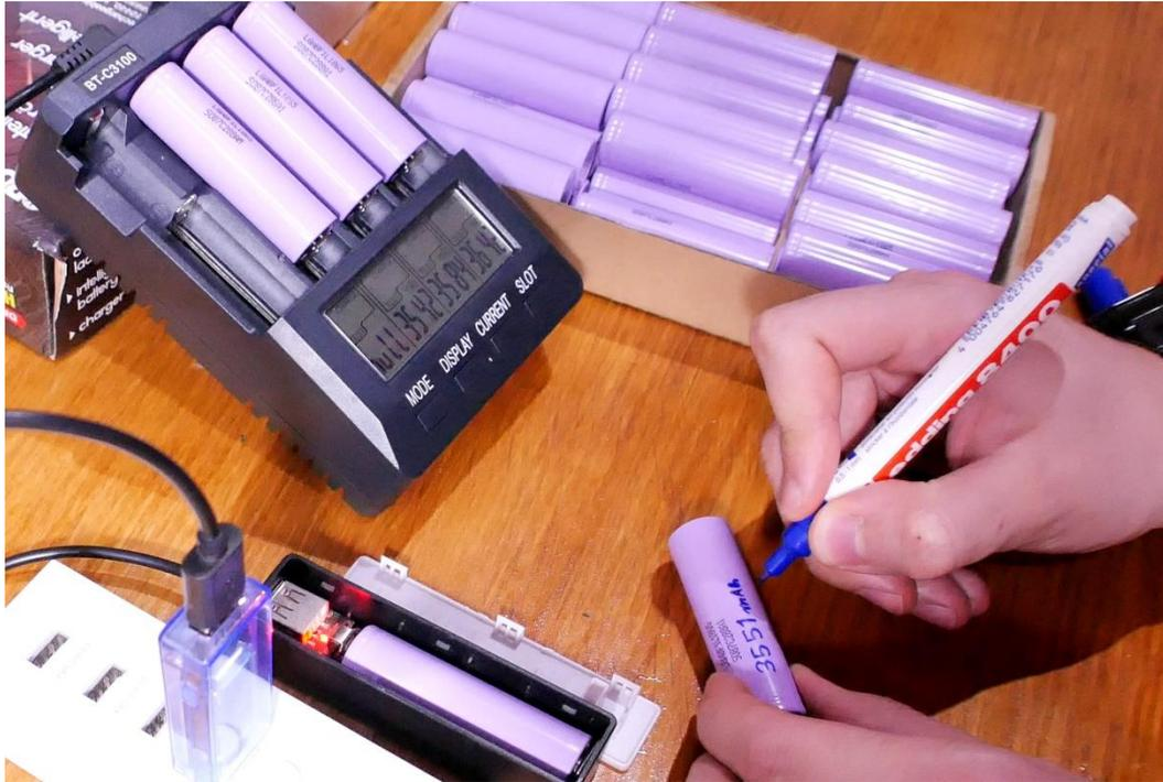
*Figura 3.25 Marcado de la capacidad real de cada celda (Fuente: Elaboración propia).*
