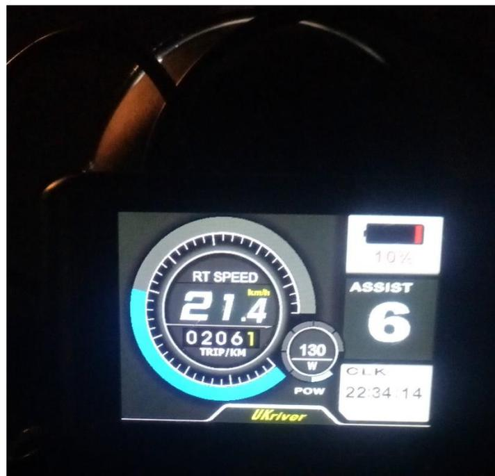
*Figura 4.1 Pantalla de la bicicleta eléctrica donde se observa el pack de baterías en funcionamiento (Fuente: Elaboración propia)*
