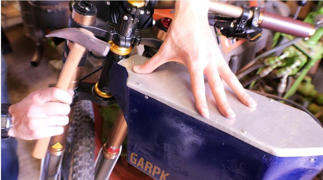
*Figura 3.46 Conformado de la chapa que servirá de tapa superior (Fuente: Elaboración propia)*
