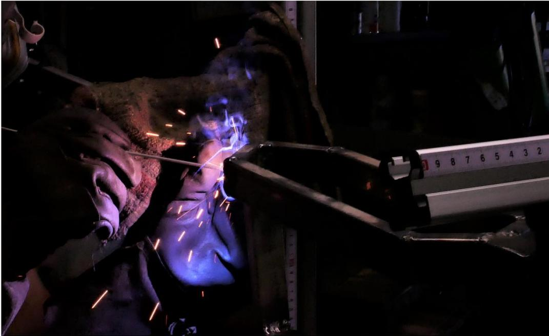
*Figura 3.50 Soldadura del cuadro de la bicicleta mediante electrodo revestido (Fuente: Elaboración propia)*
