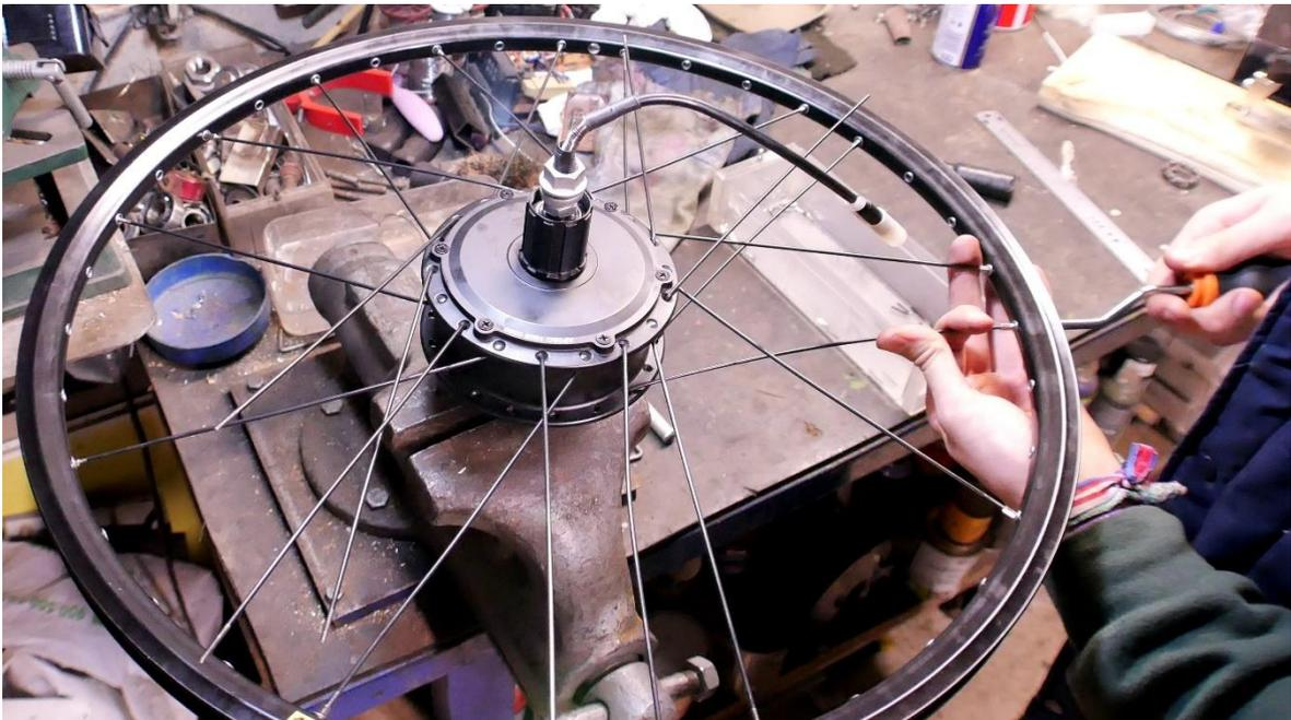
*Figura 3.5 Radiado a dos cruces del motor de buje sobre la llanta. (Fuente: Elaboración propia)*
