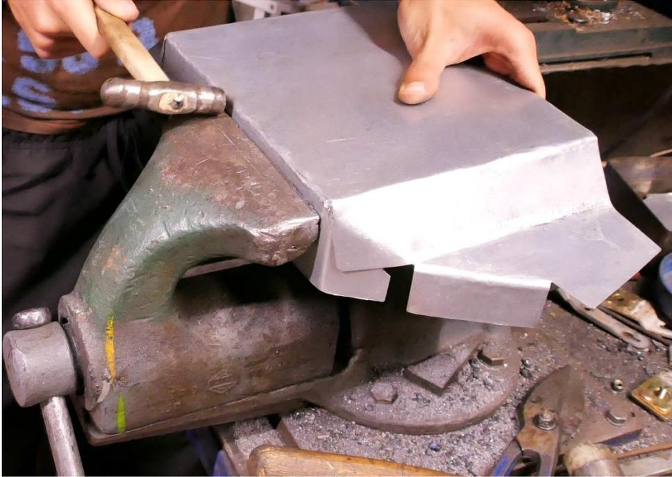
*Figura 3.42 Conformado de la chapa para la batería (Fuente: Elaboración propia).*
