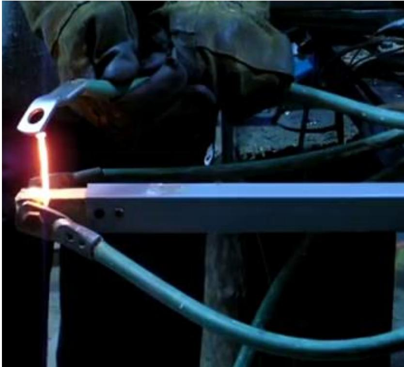
*Figura 3.69 Calentamiento de un clavo por efecto Joule (Fuente: Elaboración propia).*
