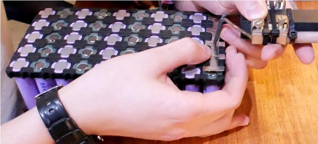
*Figura 3.31 Soldadura de la primera tira de 0.2x7.2mm de espesor (Fuente: Elaboración propia).*
