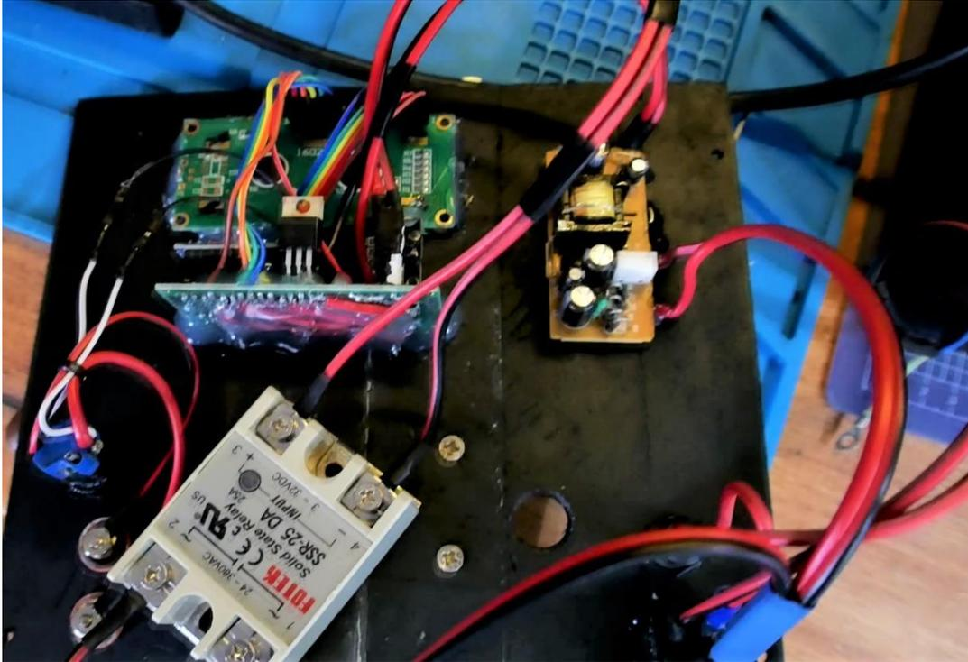
*Figura 3.78 Detalle del SSR, fuente de alimentación de 5V, LCD 16x2 y circuito (Fuente: Elaboración propia).*
