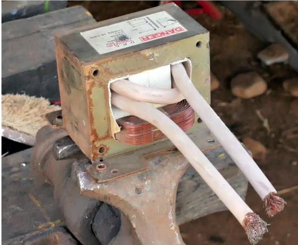
*Figura 3.70 Transformador de microondas ya modificado (Fuente: Elaboración propia).*
