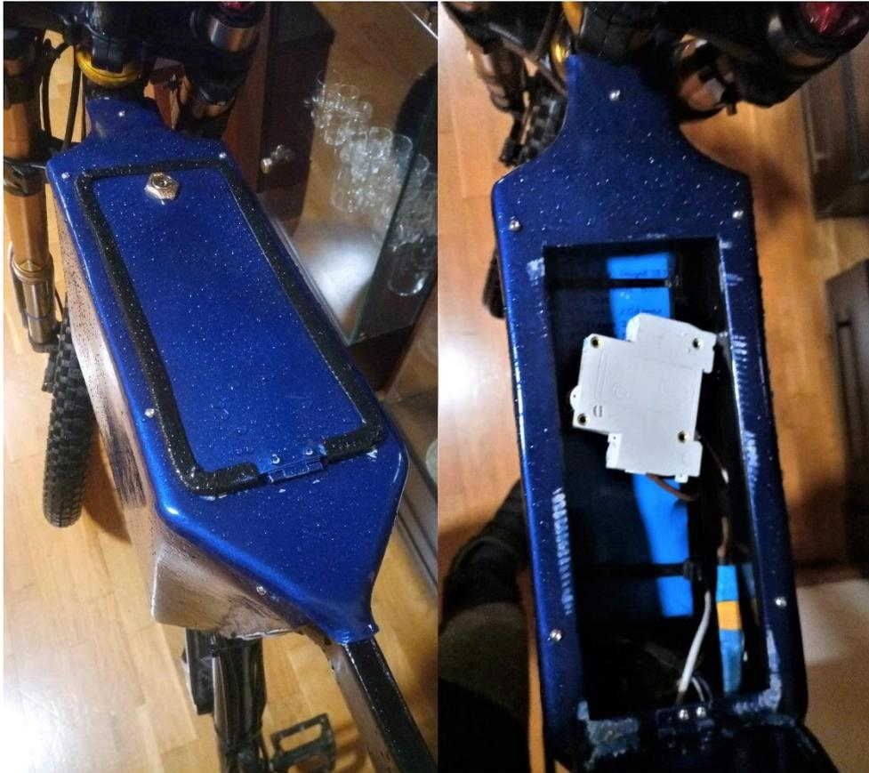
*Figura 4.2 A la izquierda, carcasa mojada por la lluvia. A la derecha, interior de la carcasa completamente seca (Fuente: Elaboración propia)*
