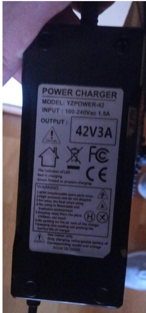
*Figura 3.48 Cargador del pack de baterías (Fuente: Elaboración propia)*
