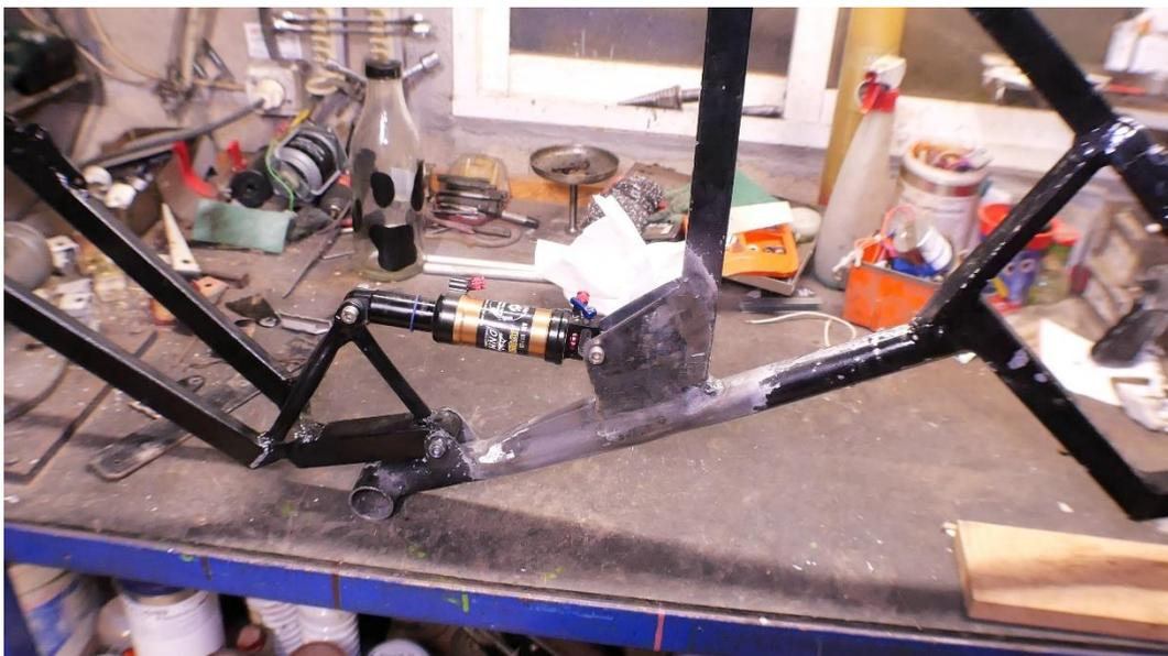
*Figura 3.51 Detalle del nuevo diseño de la suspensión (Fuente: Elaboración propia)*
