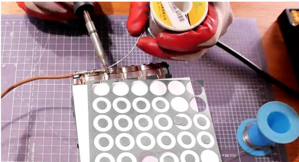
*Figura 3.36 Soldadura de la bus bar (Fuente: Elaboración propia).*
