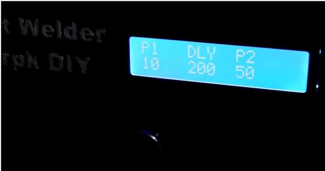
*Figura 3.85 Detalle del menú de tiempos de la soldadora (Fuente: Elaboración propia)*
