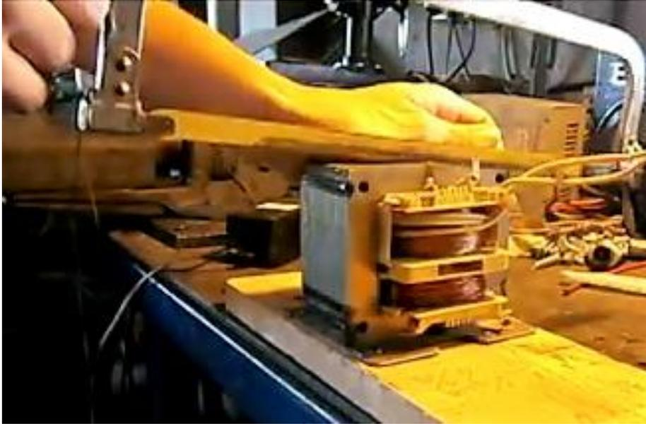
*Figura 3.68 Corte del bobinado secundario (Fuente: Elaboración propia).*
