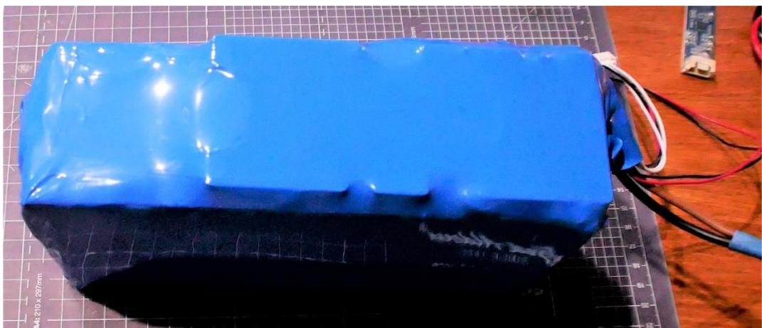
*Figura 3.40 Pack de baterías envuelto y finalizado (Fuente: Elaboración propia).*
