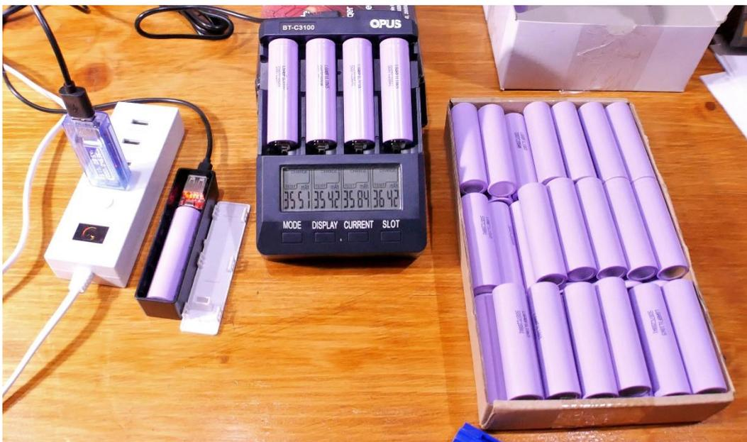
Figura 3.24 Celdas ya descargadas y con sus capacidades (Fuente: Elaboración propia).
