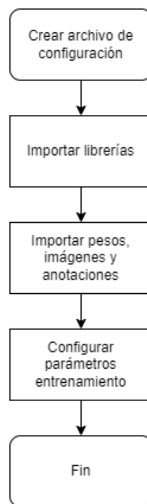
Figura 3.31. Diagrama de flujo del archivo de configuración personalizado.py
