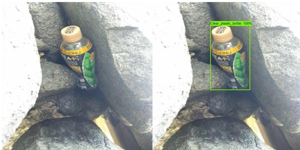
Figura 3.21. Detección errónea de la botella PET (derecha) por el modelo Fast RCNN
