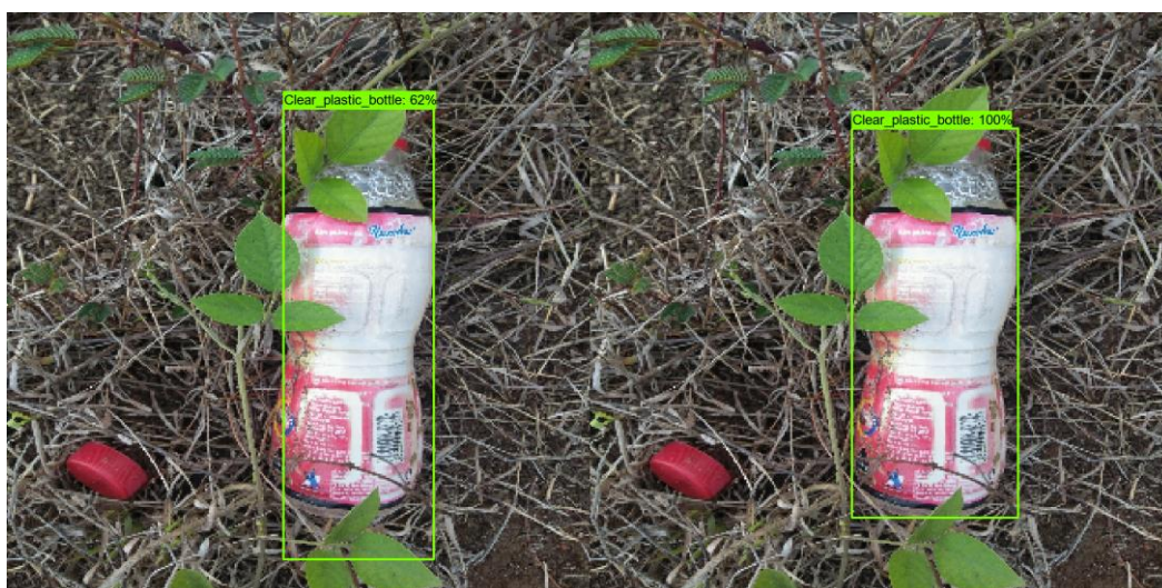
Figura 3.20. Detección correcta de la botella PET (derecha) por el modelo Fast RCNN
