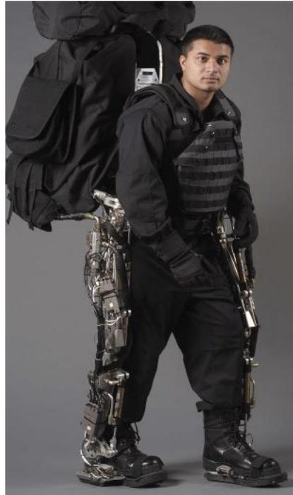
Figura 4 Exoesqueleto BLEEX (Fuente: (Zoss, et al., 2005))
