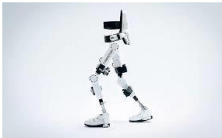
Figura 8 Traje robótico HAL extremidades inferiores (Fuente: (<https://www.xataka.com>, s.f.))
