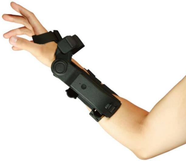
Figura 19 Exoesqueleto EXOS Wrist DK2 (Fuente: (Exiii inc., s.f.))
