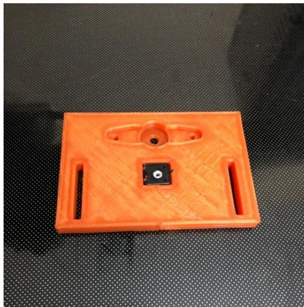
Figura 44 Agarre mano con potenciómetro (Fuente: elaboración propia)
