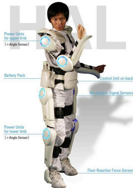
Figura 7 Traje robótico Hal completo (Fuente: (<https://tendencias2009.wordpress.com>, s.f.))
