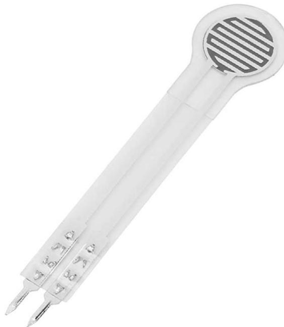
Figura 32 Sensor FSR (Fuente: (Amazon, s.f.))
