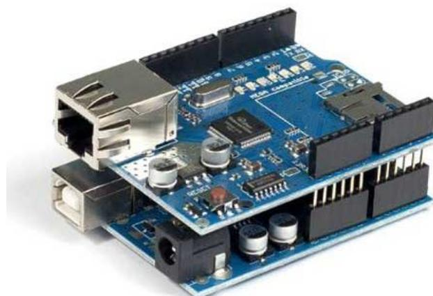
**Figura 6.5.** Conexión Ethernet Shield y Arduino UNO (Fuente: [88])
