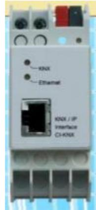
**Figura 2.6.** Ejemplo pasarela KNX<->Ethernet (Fuente: [5])
