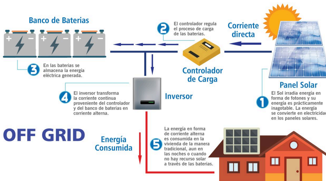
Figura 2.1. Instalación aislada (off-grid). Fuente: [20]
