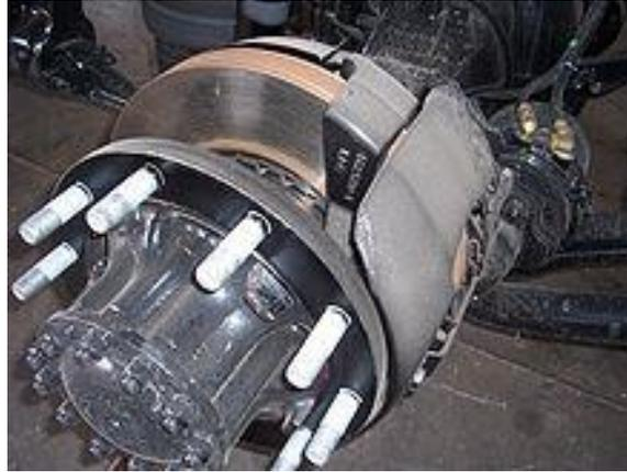
Figura 4.1 Freno neumático
