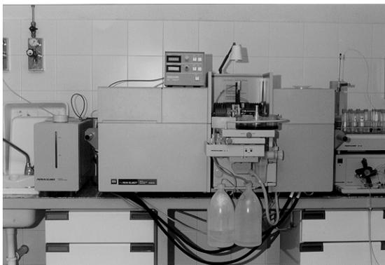
**Figura 4.** Equipo Perkin Elmer 4100ZL con Espectrof6tmetro de Absorci6n at6mica y c6mara de grafito.
