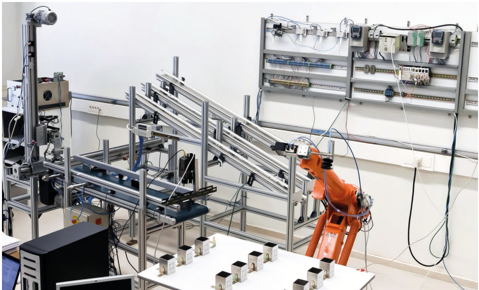
Figura 7.6. Célula de clasificación robotizada
