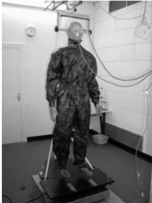
Figura 6. Maniquí térmico móvil para ensayos del comportamiento de la ropa.
