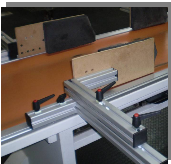
Figura 4.3.4. Detalle de los soportes.
