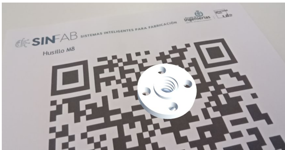
Figura 1. visualización de los elementos mecánicos desde la aplicación de realidad aumentada.
