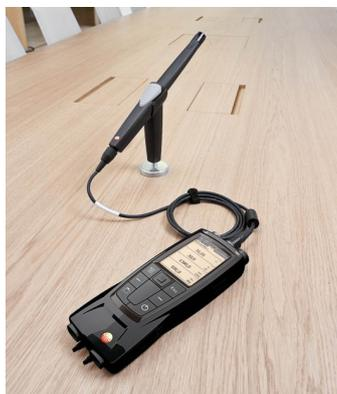
Figura 4.20. - Aparato para medir ambiente térmico
