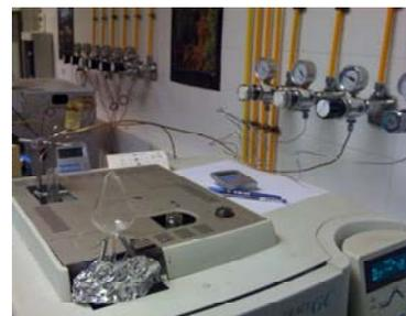
**Figura 3.10:** Representación esquemática y en imagen real del dispositivo empleado en la obtención de los extractos para el análisis mediante GC-O (izquierda). A la derecha, se observa el GC-FID con puerto olfatométrico donde se realizan las olfatometrías.
