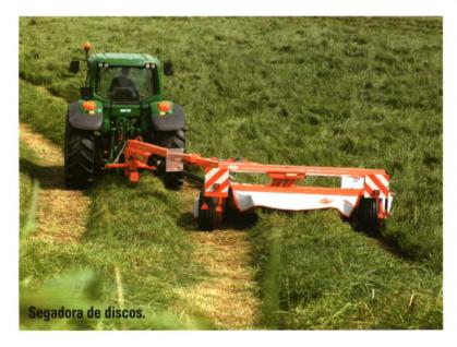
Como sistema de seguridad dispone de un tornillo fusible que protege a la barra de tropiezos con obstáculos como piedras. La calidad del corte que realiza es la mejor que podemos conseguir con las máquinas actualmente en utilización.
