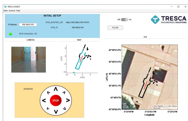
Figura 5: HMI en tiempo real. El mapa se representa en color negro, la trayectoria en rojo y el escaneo LiDAR actual en color azul.
