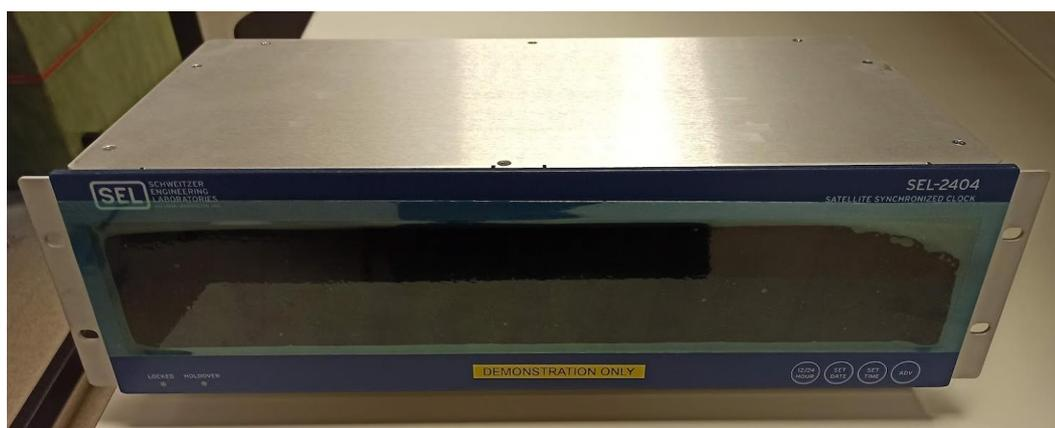
**Figura 3.6: Parte anterior del reloj de sincronización SEL-2404 (Fuente: elaboración propia)**
