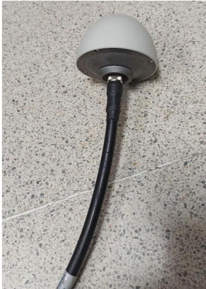
**Figura 6.28: Antena GPS utilizada, marca Trimble (SEL-2404) (Fuente: elaboración propia)**
