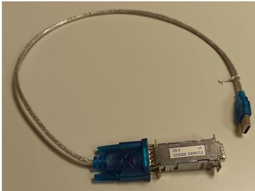
**Figura 6.23: Conversor USB-Serial utilizado para las configuraciones (Fuente: elaboración propia)**
