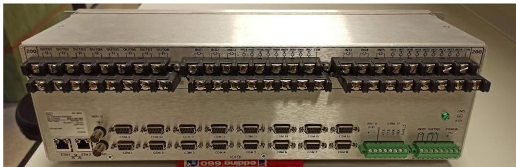
Figura 3.10: Parte posterior del controlador RTAC SEL-3530 (Fuente: elaboración propia)
