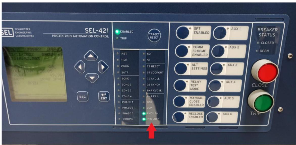
**Figura 6.22: Activación de indicadores frontales de recepción de señal IRIG-B adecuada (SEL-421-5) (Fuente: elaboración propia)**
