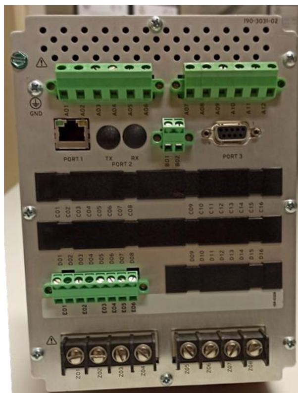
Figura 3.2: Parte posterior del relé de protección SEL-751A (Fuente: elaboración propia)
