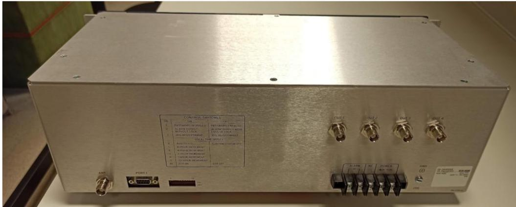
**Figura 3.7: Parte posterior del reloj de sincronización SEL-2404 (Fuente: elaboración propia)**
