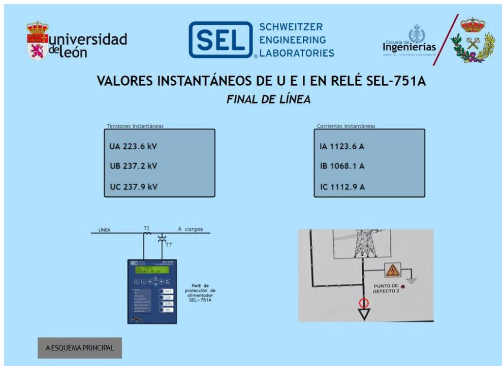
Figura 7.3: Valores instantáneos al final de línea (línea de 46 km con carga impedante) (Fuente: elaboración propia)
