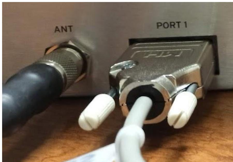
**Figura 6.27: Puertos de conexión de antena, ANT y serie, PORT 1 (SEL-2404)
