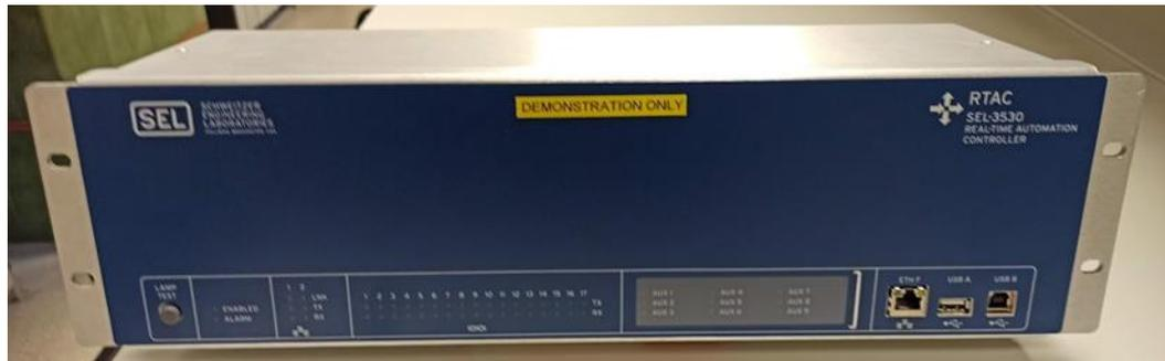
Figura 3.9: Parte anterior del controlador RTAC SEL-3530 (Fuente: elaboración propia)
