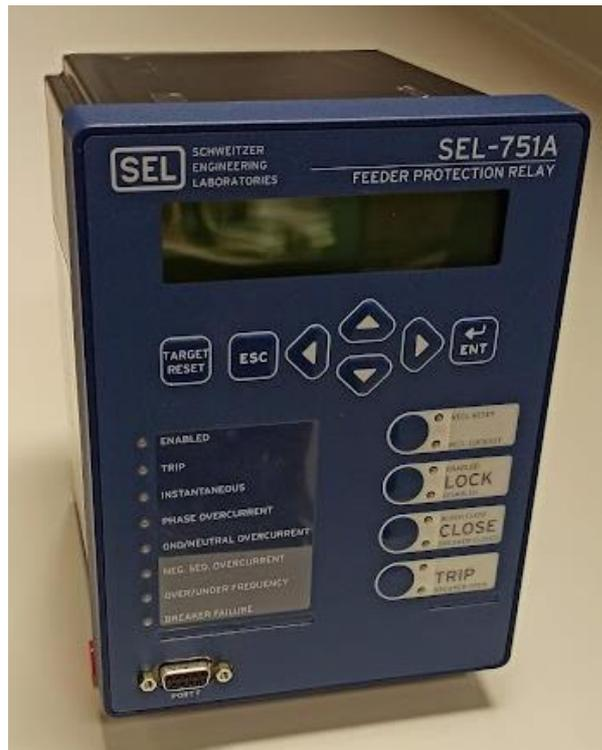
Figura 3.1: Parte anterior del relé de protección SEL-751A (Fuente: elaboración propia)
