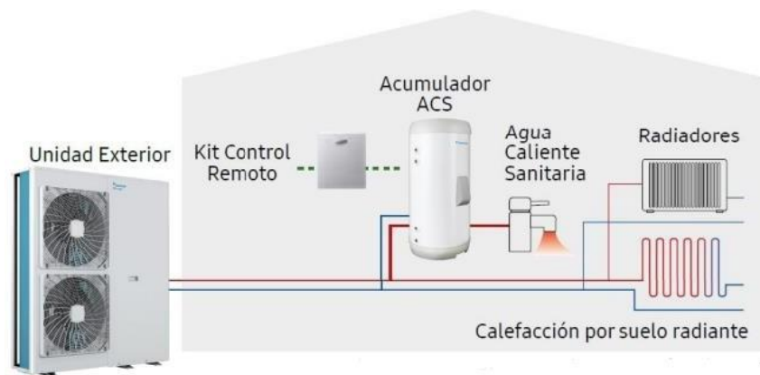
Ilustración 7.4 Sistema bibloc. (Fuente: Gasfriocalor)
