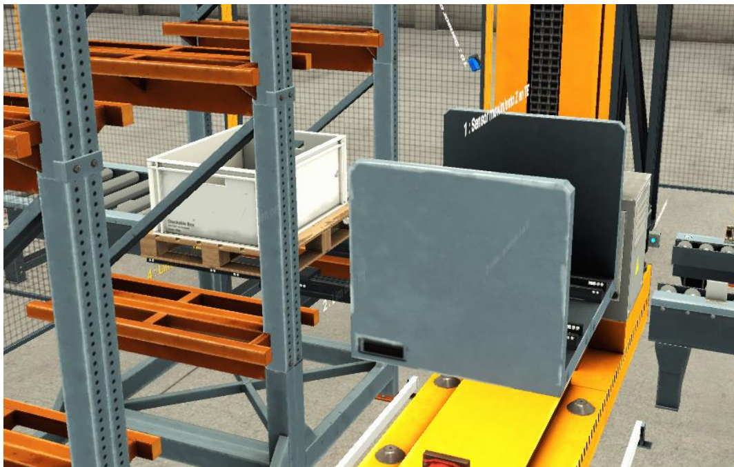
Figura 5.46 Despliegue de dientes para ubicar el pallet en el almacén.
