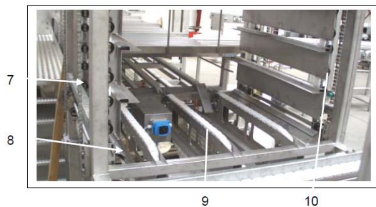
Figura 5.10 Sistema de recepción vertical para cinco cajas Maxi Load (II). (Fuente: Manual LINCO Food Systems,1_31 – Receptor vertical)
