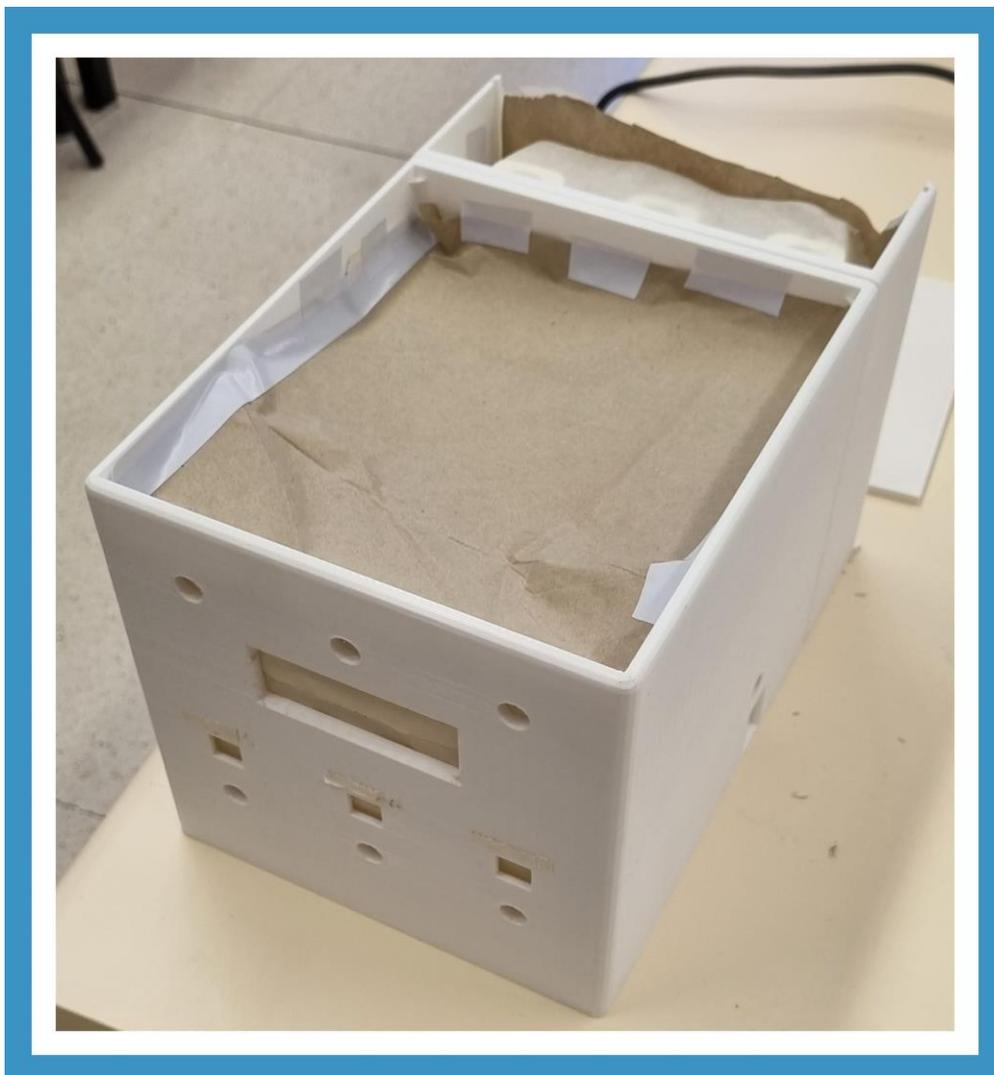
Figura 2.19. Fotografía del prototipo después del segundo lijado y preparado para el siguiente proceso (Fuente: Elaboración propia)
