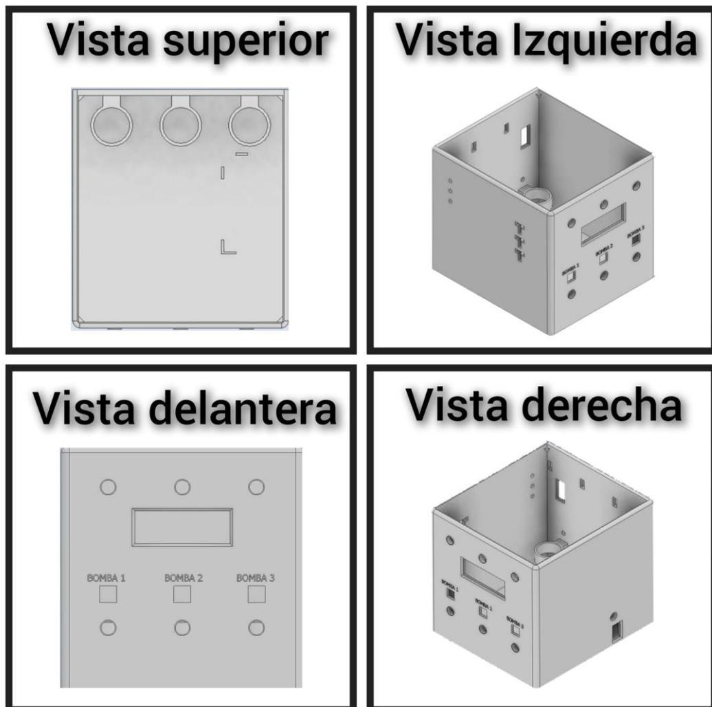
Figura 2.9. Diseño de la caja delantera del prototipo desde diferentes perspectivas (Fuente: Imágenes obtenidas de Autodesk Inventor y editadas por Javier Álvarez Santos)
