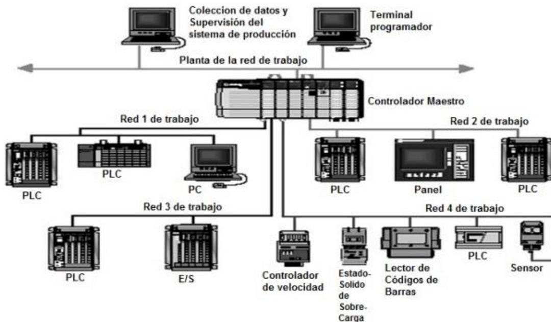
*Figura 3.2.2.1. Arquitectura maestro-esclavo. (Fuente: Controladores lógicos programables UNED)*
