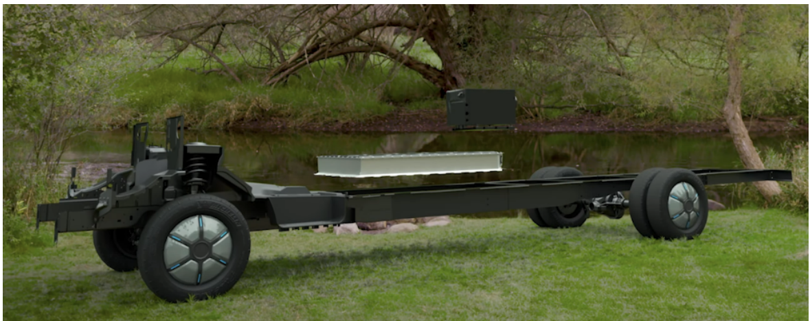
Figura 1.2. Posición baterías camper Thor Industries (Fuente: Thor Industries)
