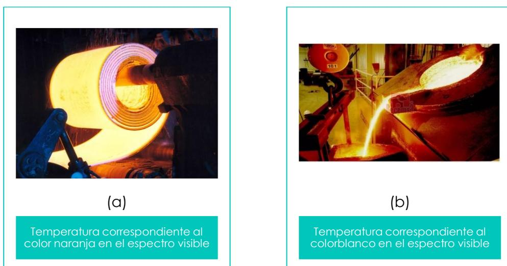
Figura 2.3.3: Pieza de metal laminado (a) y colada (b) a temperaturas que provocan una emisión de radiación en el espectro visible correspondientes al color blanco. [8]
