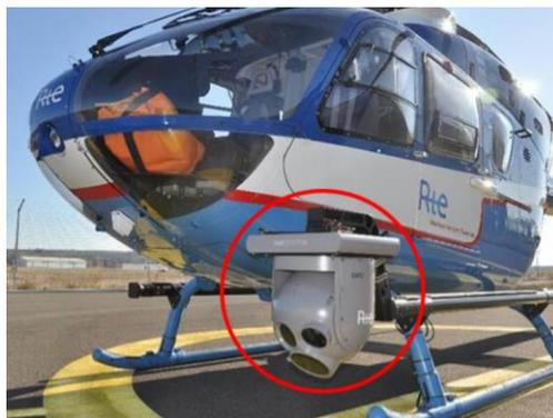
Figura 4.8.2: Helicóptero con sistema GIMBAL montado en la parte delantera. [19]
