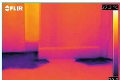
Figura 4.1.3: Imagen infrarroja de una filtración de humedad en el suelo. [16]
