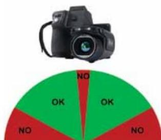
Figura 5.3.2: Ángulo de visión recomendado (verde) ya a evitar (rojo) al realizar inspecciones termográficas. [17]
