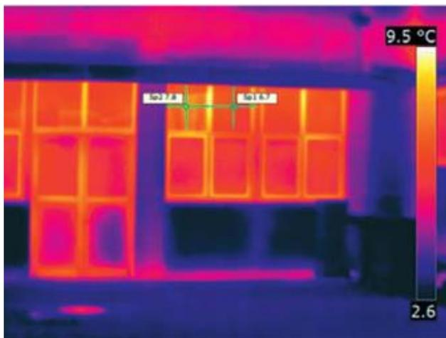
Figura 3.9.1: Imagen Infrarroja de las ventanas de una fachada. [1]
