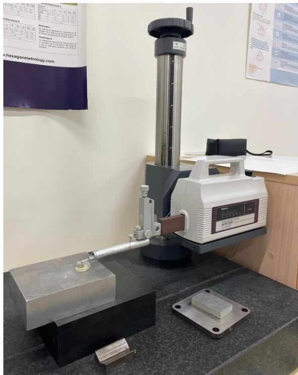
*Figura 7.17. Fotografía del perfilómetro-rugosímetro utilizado para el análisis. [Imagen de elaboración propia]*
