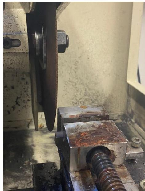
Figura 7.6. Fotografía de la máquina cortadora metalográfica. [Imagen de elaboración propia]
