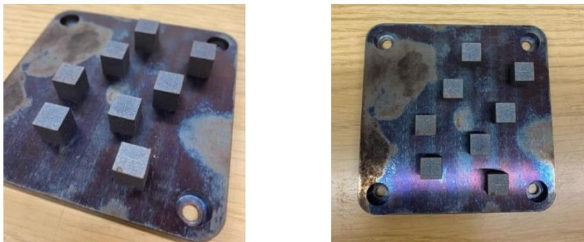
Figura 7.2. Fotografía de la placa con los ocho cubos de acero 17-4PH fabricados por SLM. [Imagen de elaboración propia]
