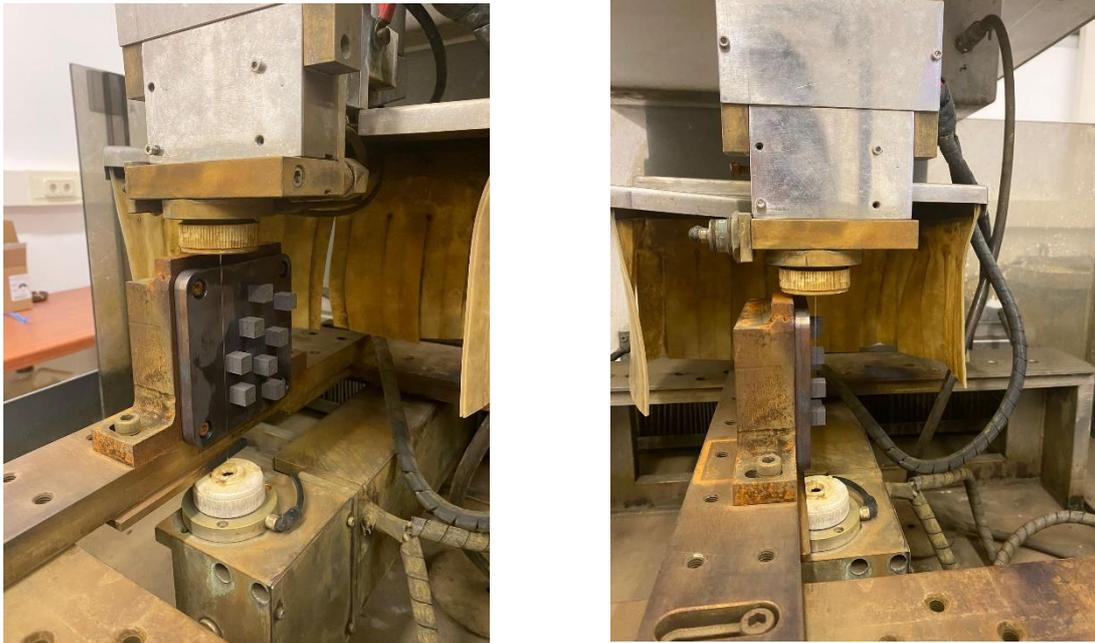
Figura 7.4. Fotografía de la placa colocada en la máquina de corte por hilo. [Imagen de elaboración propia]
