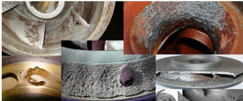
*Figura 4.8. Defectos causados por el desgaste de cavitación. [16]*
