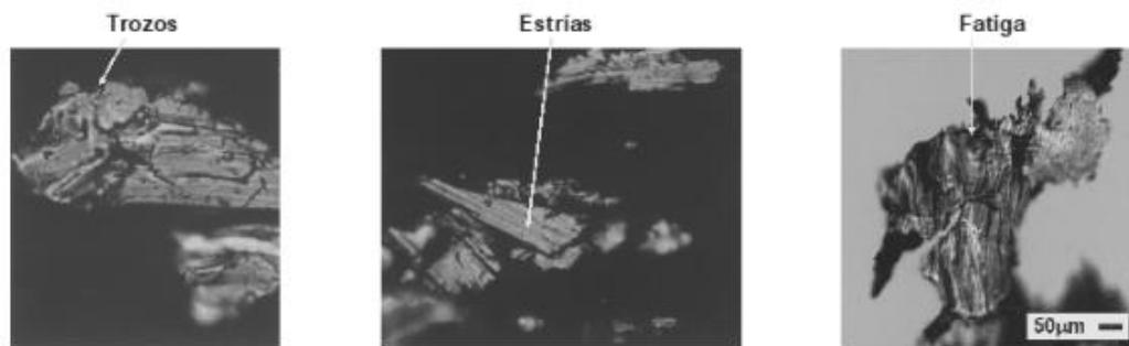
Figura 4.5. Diferentes tipos de partículas de desgaste adhesivo. [11]
