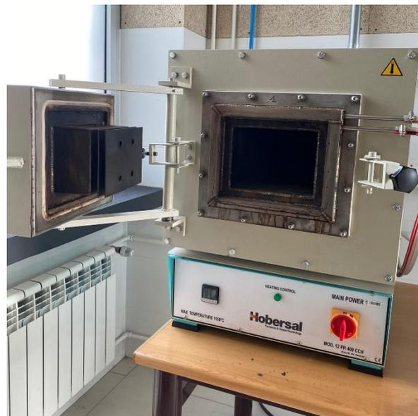
Figura 7.5. Fotografía del horno en el que se llevaron a cabo los tratamientos térmicos. [Imagen de elaboración propia]
