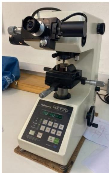
Figura 7.10. Fotografía del microdurómetro utilizado en el laboratorio. [Imagen de elaboración propia]
