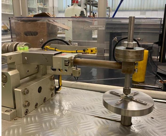
*Figura 7.15. Fotografía del ensayo de desgaste circular en marcha. [Imagen de elaboración propia]*
