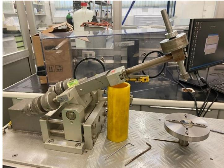
Figura 7.14. Fotografía del tribómetro para realizar los ensayos de desgaste circular. [Imagen de elaboración propia]
