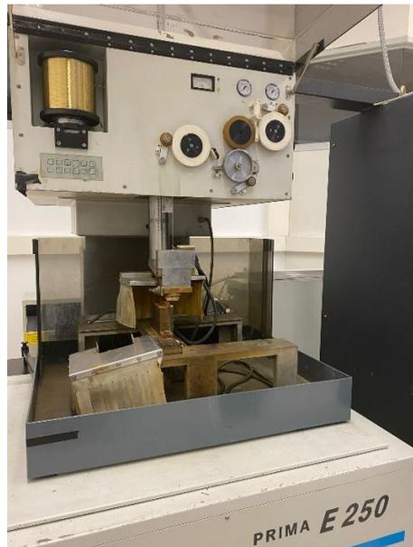
Figura 7.3. Fotografía de la máquina de corte por hilo. [Imagen de elaboración propia]
