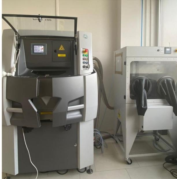
Figura 7.1. Fotografía de la máquina de fabricación SLM de la Escuela de Ingenierías (Edificio MIC). [Imagen de elaboración propia]
