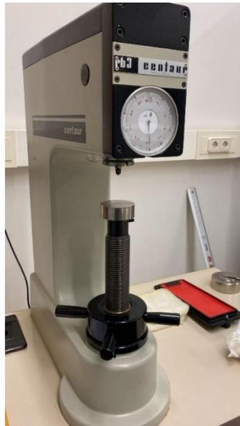
Figura 7.13. Fotografía del macrodurómetro utilizado. [Imagen de elaboración propia]
