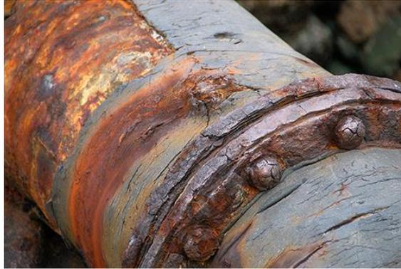
Figura 4.9. Defecto causado por el desgaste corrosivo. [17]
