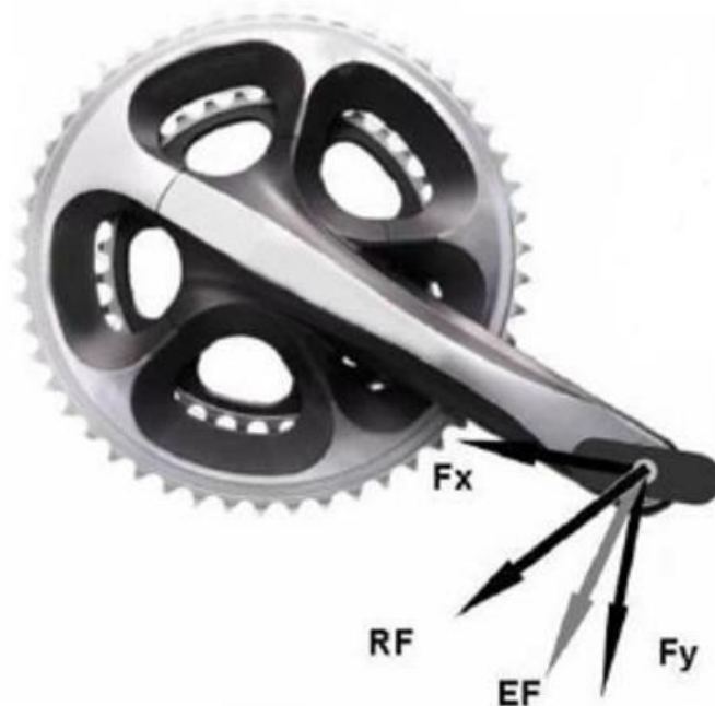
Ilustración 7. Fuerzas sobre la biela (Fuente: [12] )
