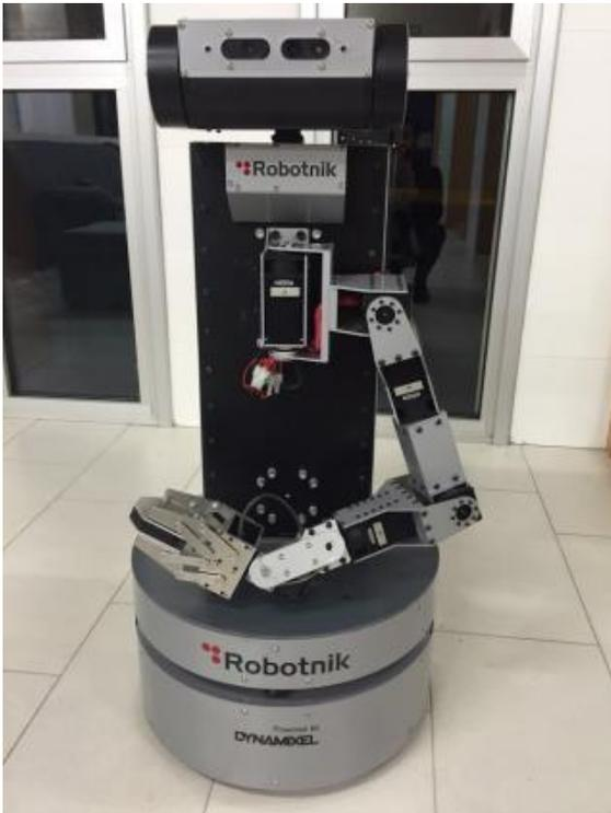
Figura 3.14 Robot RB-1 [28]
