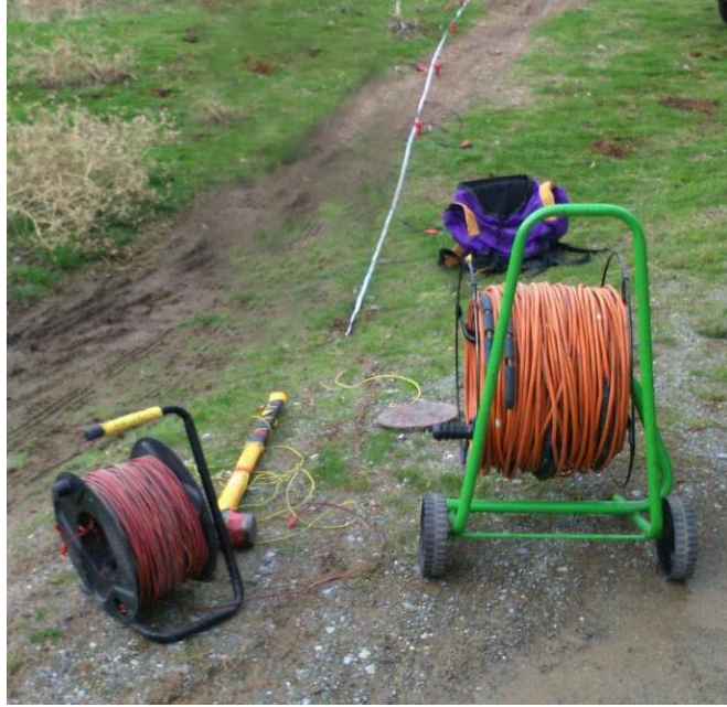
Figura 3.3 Cableado para los geófonos.
