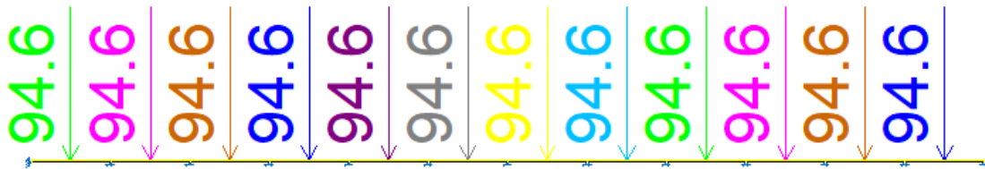
Ilustración 6: Hipótesis de cargas sobre la viga carril. Fuente: CYPE 3D.
