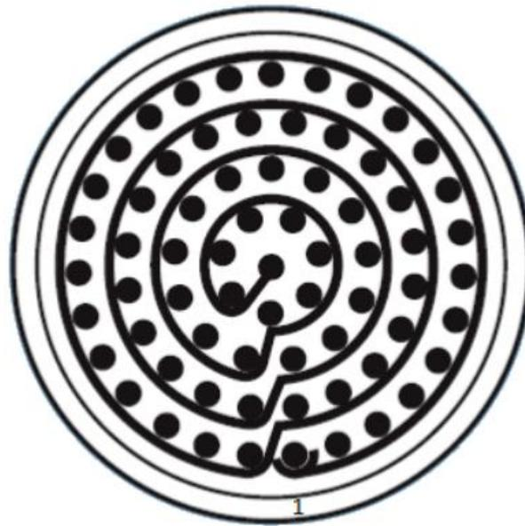
Figura 5.5.- Conector redundante de 68 pines Veronte 4x
