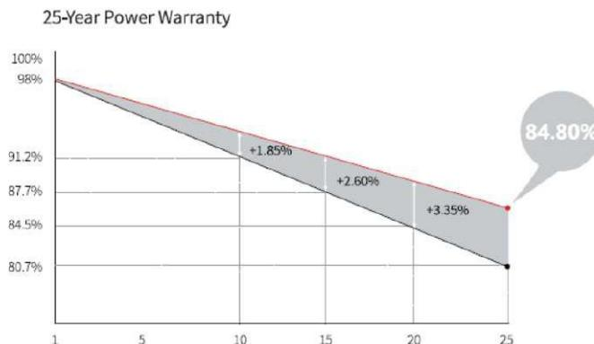
Figura 4.2 Garantía de producción panel solar Longisolar. (Fuente: “ [6] Paneles solares Longisolar”)
