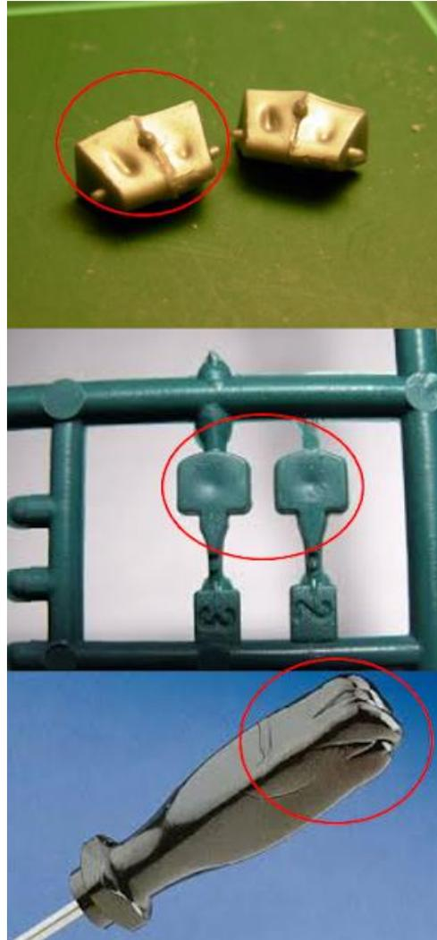
*Ilustración 1.7 Defecto por rechupe. (Fuente: [7])*
