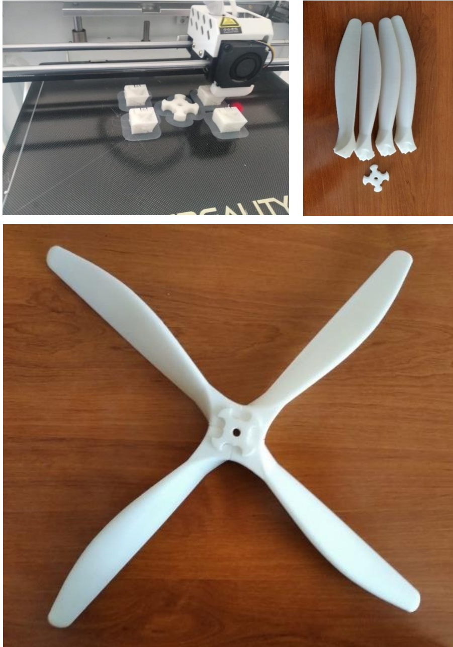
Figura 8.17. Fabricación y resultado final de la elaboración de la hélice
