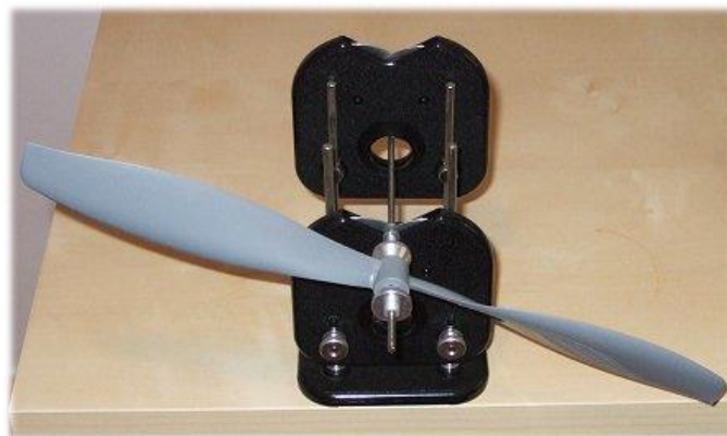
Figura 7.4. Equilibrado de hélices a escala [43]
