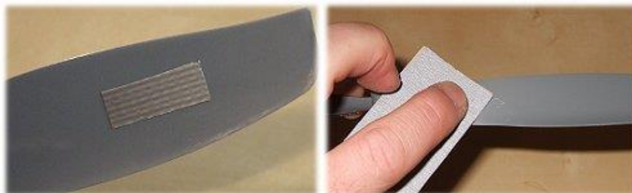
Figura 7.5. Equilibrado de hélices pequeñas pegando cinta en el intradós de las palas ligeras [43]
