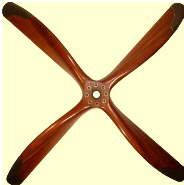
Figura 2.2. Una de las hélices montadas en el Airco De. H4 [6]
