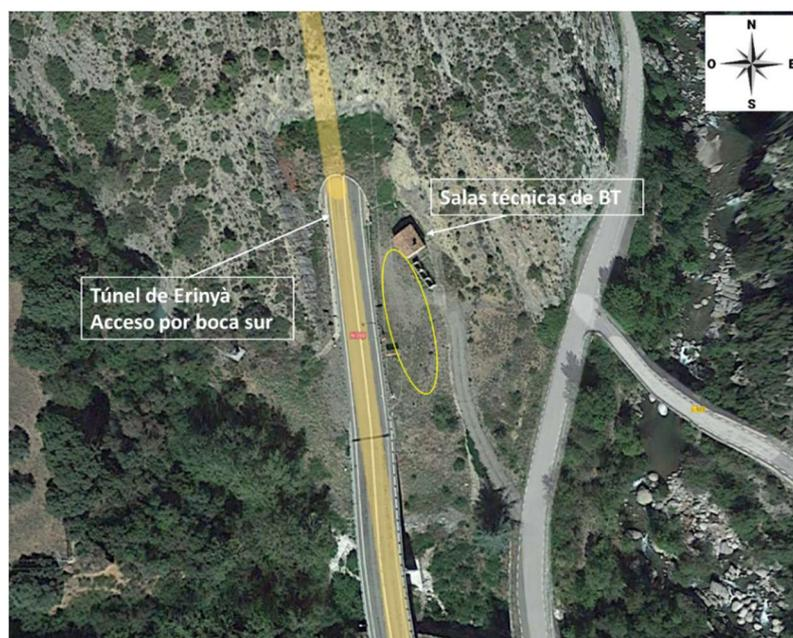
**Figura 3.40. Opción 2. Ubicación planta fotovoltaica anexa a las salas técnicas. Fuente: elaboración propia a partir de imagen aérea de Google earth**
