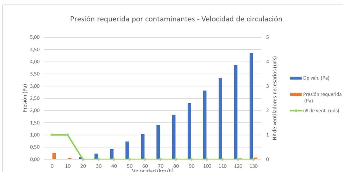
**Figura 3.11. Requisitos nivel de servicio. Efecto pistón y nº de ventiladores. Fuente: elaboración propia**
