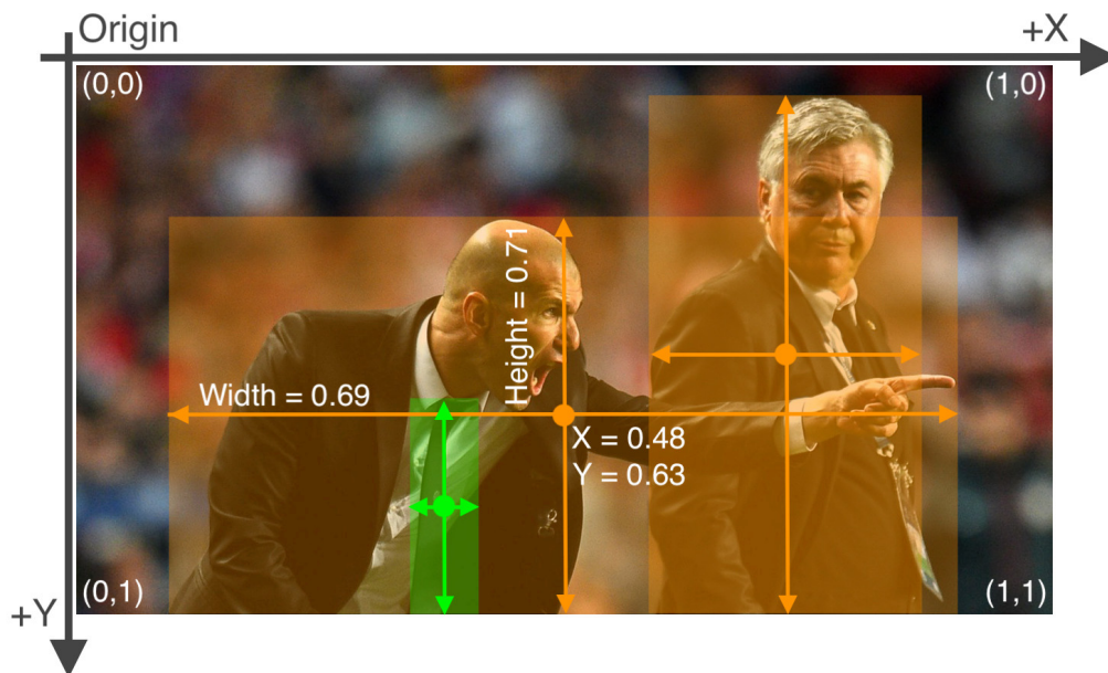
Figura 3.1: Imagen con bounding boxes dibujadas [31]
