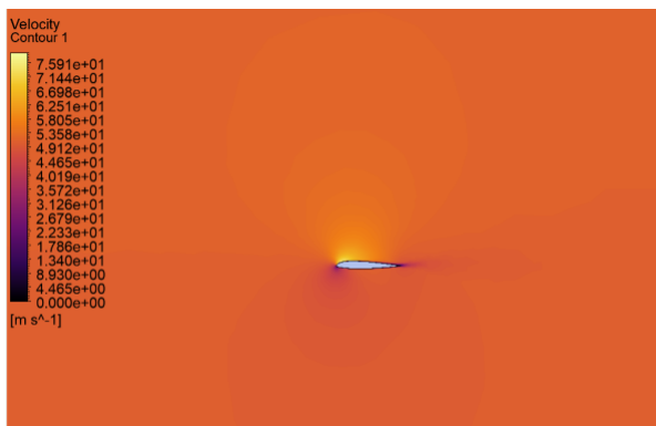
Figura 6.64: Perfil de velocidades de la pala del rotor del BO-105 con un ángulo de ataque de 5°. Fuente: Elaboración propia
