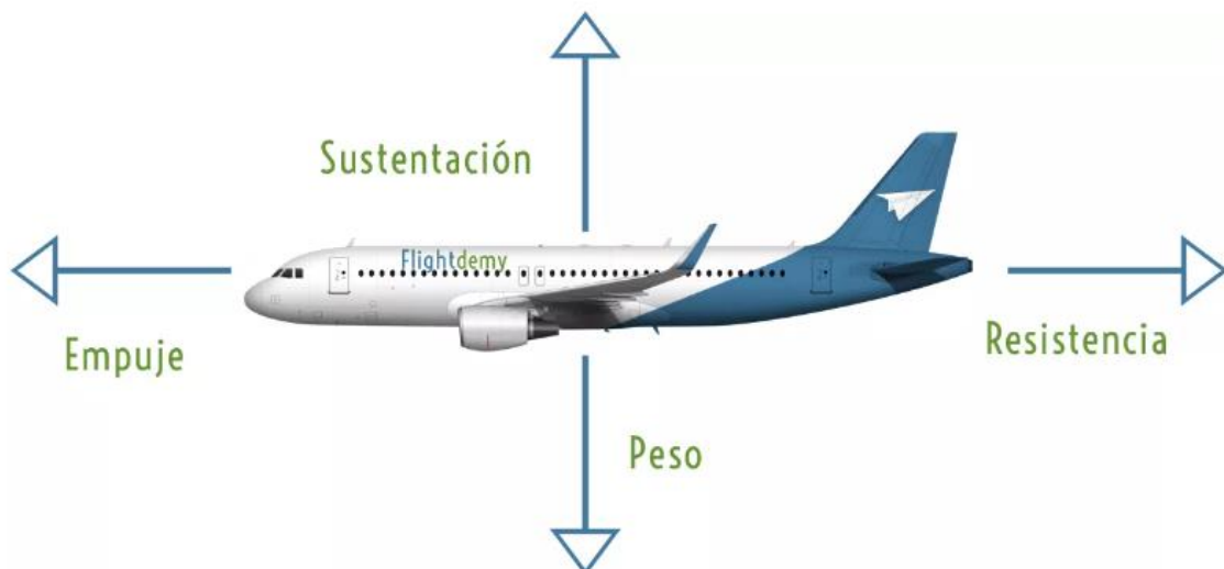
Figura 1.1. Fuerzas que actúan sobre una aeronave en vuelo (Fuente [8])
