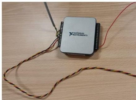
Figura 4.3. Tarjeta de adquisición de datos conectada al Pitot. (Fuente: elaboración propia)
