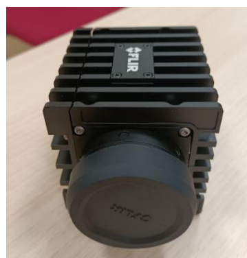
Figura 4.5. Cámara FLIR A50/A70 utilizada para el experimento.
