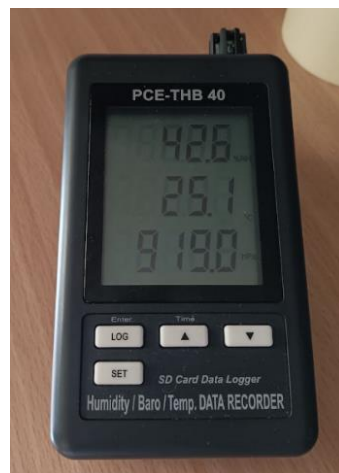
Figura 4.12. Higrómetro digital empleado para medir las condiciones de P, T y humedad. (Fuente: elaboración propia)
