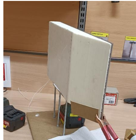
Figura 4.11. Panel de aislante con el chaflán desde el borde de ataque.
