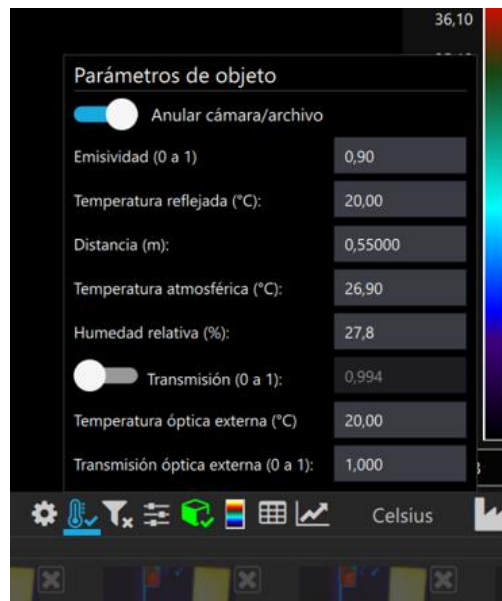
Figura 4.7. Parámetros de objeto que se muestran en el software FLIR Research Studio. (Fuente: elaboración propia)
