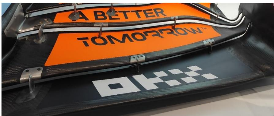
Figura 3.1. En gris, los rigidizadores del alerón delantero del McLaren MCL36 del 2022.
