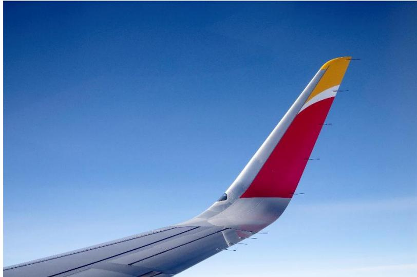
Figura 2.31. Winglet de un Airbus A320. (Fuente:[33])
