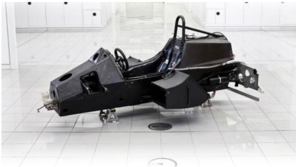
Figura 1.5. Chasis monocasco del McLaren MP4/1. (Fuente:[10])
