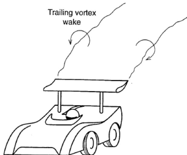
Figura 1.23. Vórtices de punta del alerón trasero de un coche de competición. (Fuente: [17])
