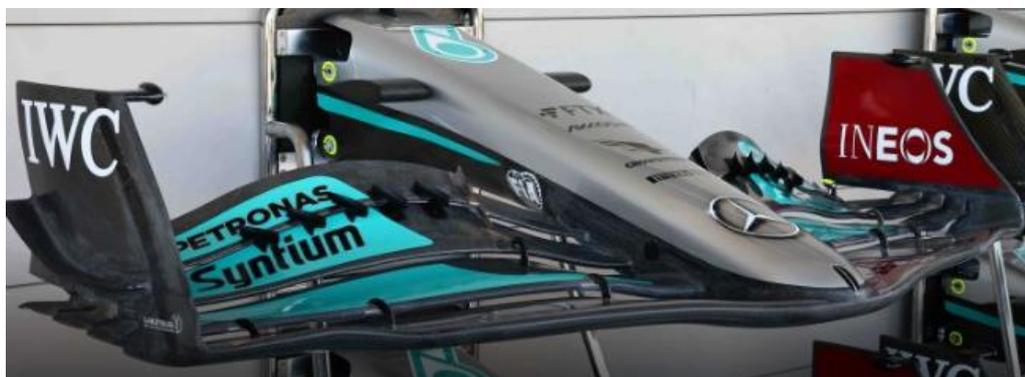
Figura 3.2. Alerón delantero del Mercedes W13 de 2022 con la fijación de la parte central del plano principal al morro del monoplaza. (Fuente: [36])
