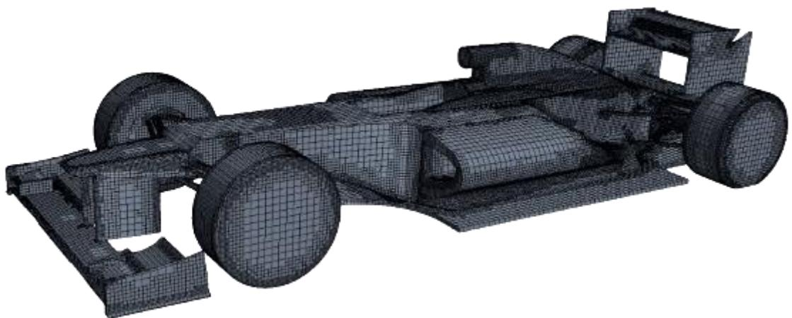
Figura 2.2. Mallado de un coche de F1. (Fuente:[28])
