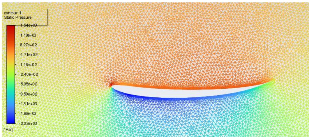
Figura 2.24. Distribución de la presión estática en el perfil final del plano principal del alerón delantero. (Fuente: Elaboración propia)
