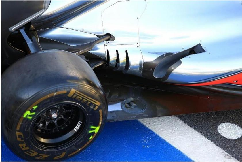
Figura 1.25. Escape del McLaren MP4/27 de efecto Coanda. (Fuente: [23])
