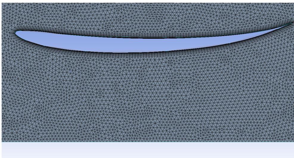
Figura 2.18. Mallado del perfil Eppler 58 para el análisis de efecto suelo. (Fuente: Elaboración propia)
