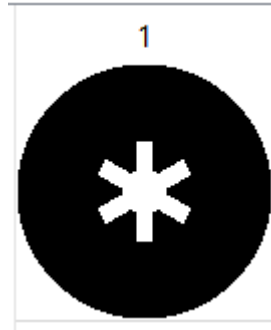
Figura 6.25 Geometría del grano de los dos pulsos del motor de la segunda etapa. Esta geometría ofrece un perfil de empuje relativamente constante, además de un porcentaje de volumen ocupado (eficiencia volumétrica) del 90.96%.
