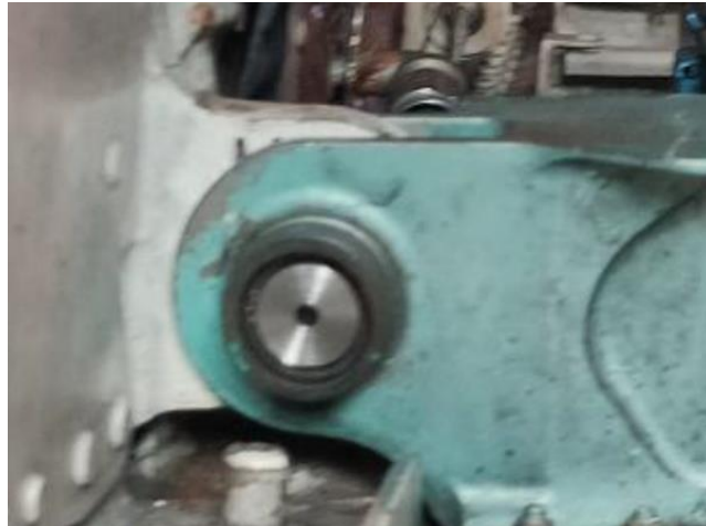
Figura 5.12: Colocación de la guía en la orejeta. (Fuente: Elaboración propia)
