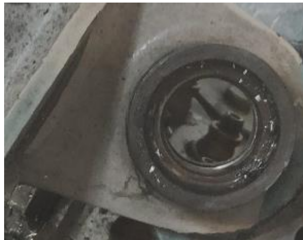
Figura 5.14: Ficha de aluminio una vez conformado el taladro interior. (Fuente: Elaboración propia)
