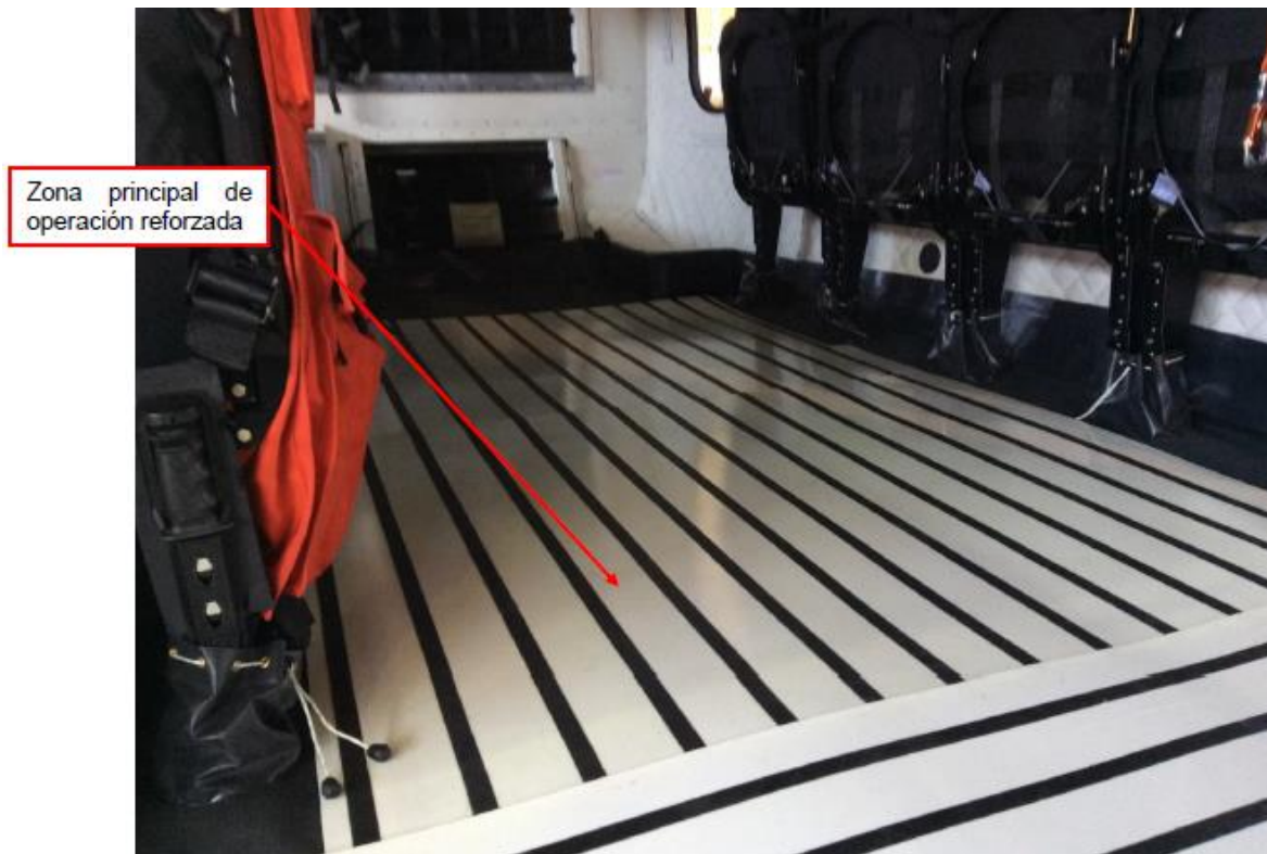
Figura C.4: Refuerzo de la zona principal de operación del helicóptero. (Fuente: [29])
