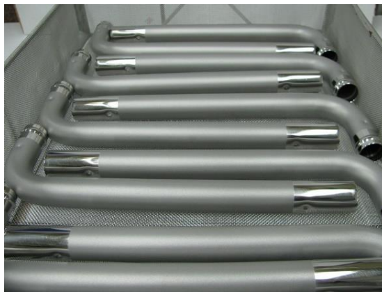
Figura 3.18: Tratamiento superficial de pasivado de aceros
