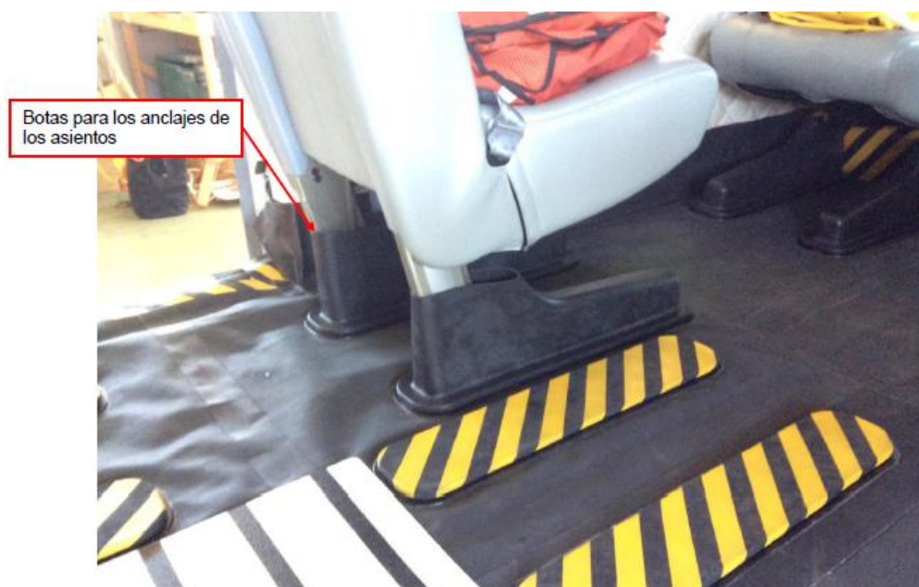
Figura C.2: Botas para evitar que el agua entre a través de los anclajes de los asientos. (Fuente: [29])
