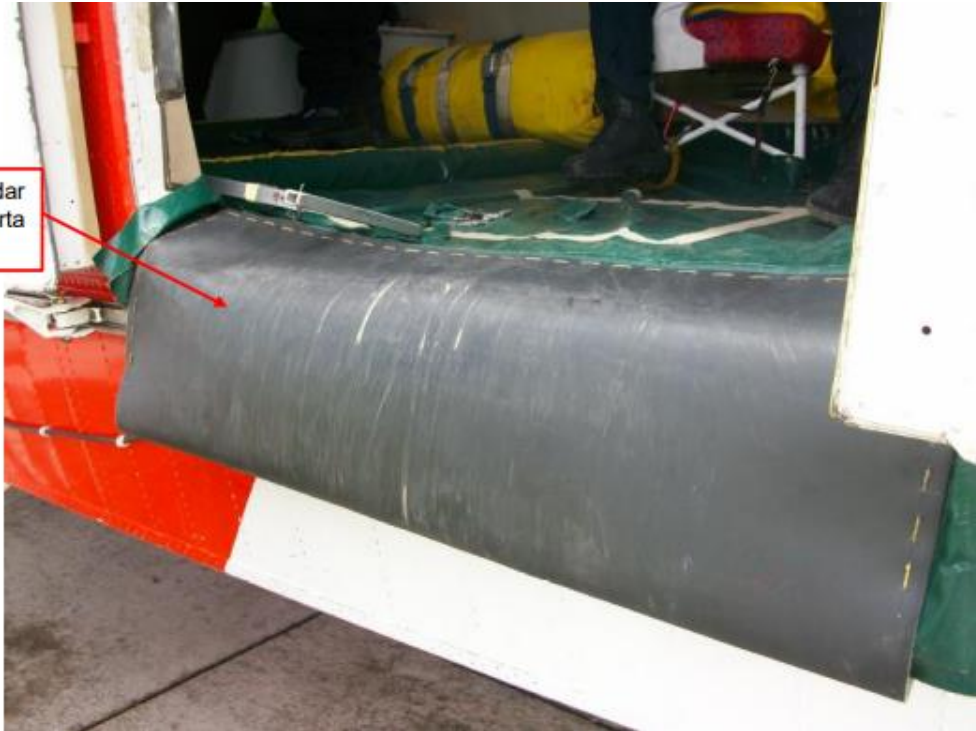
Figura D.7: Faldón de la puerta. (Fuente: [29])
