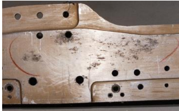
Figura 2.9: Pitting en el acoplamiento de aluminio del ala.
