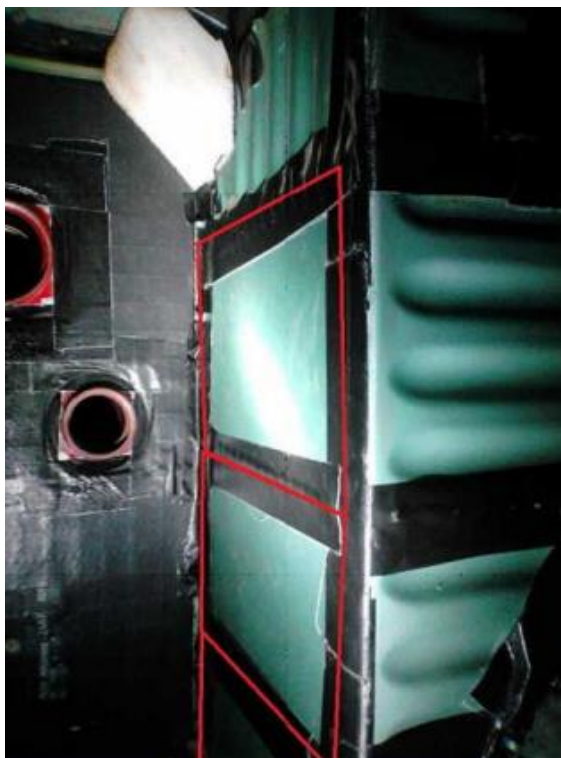
Figura 5.27: Espumas y cinta negra recubriendo la zona de inspección. Se muestra el lado izquierdo. (Figura: [35])
