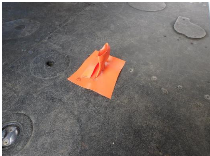
Figura E.2: Posición abierta del acceso. Tubo extensible para permitir la instalación de la fijación de las camillas. (Fuente: [31])
