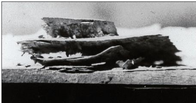
Figura 2.13: Ejemplo de exfoliación vista desde el canto de la lámina. (Fuente: [1])
