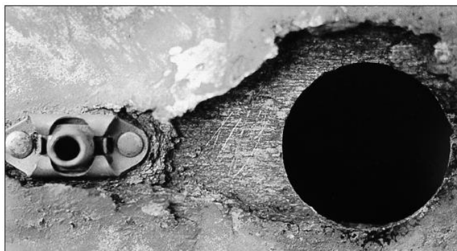
Figura 2.14: Exfoliación de metal en contacto con un fijador. (Fuente: [1])
