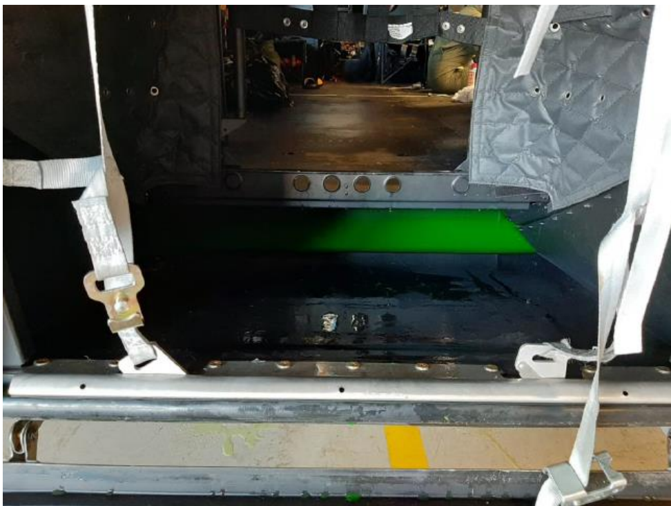
Figura 5.21: Agua estancada en la rampa del maletero, acceso por la puerta trasera. (Fuente: Elaboración propia).
