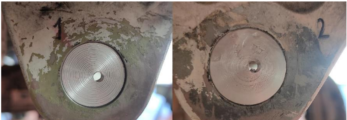
Figura 5.13: Taladros realizados en las fichas de aluminio. (Fuente: Elaboración propia)
