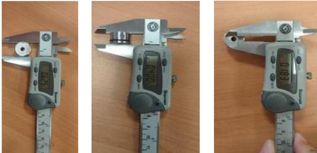
Figura 5.10: Medidas del pestillo. (Fuente: Elaboración propia)
