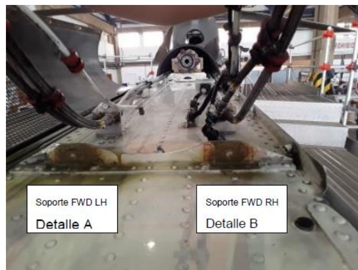
Figura 5.6: Situación del soporte con corrosión. (Fuente: Elaboración propia)
