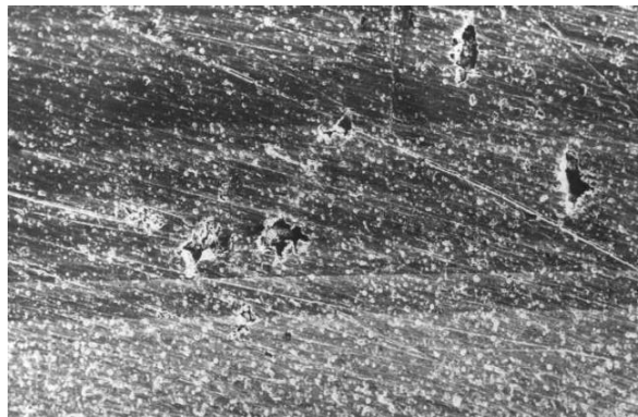
Figura 2.10: Picaduras en una aleación de aluminio y cobre.
