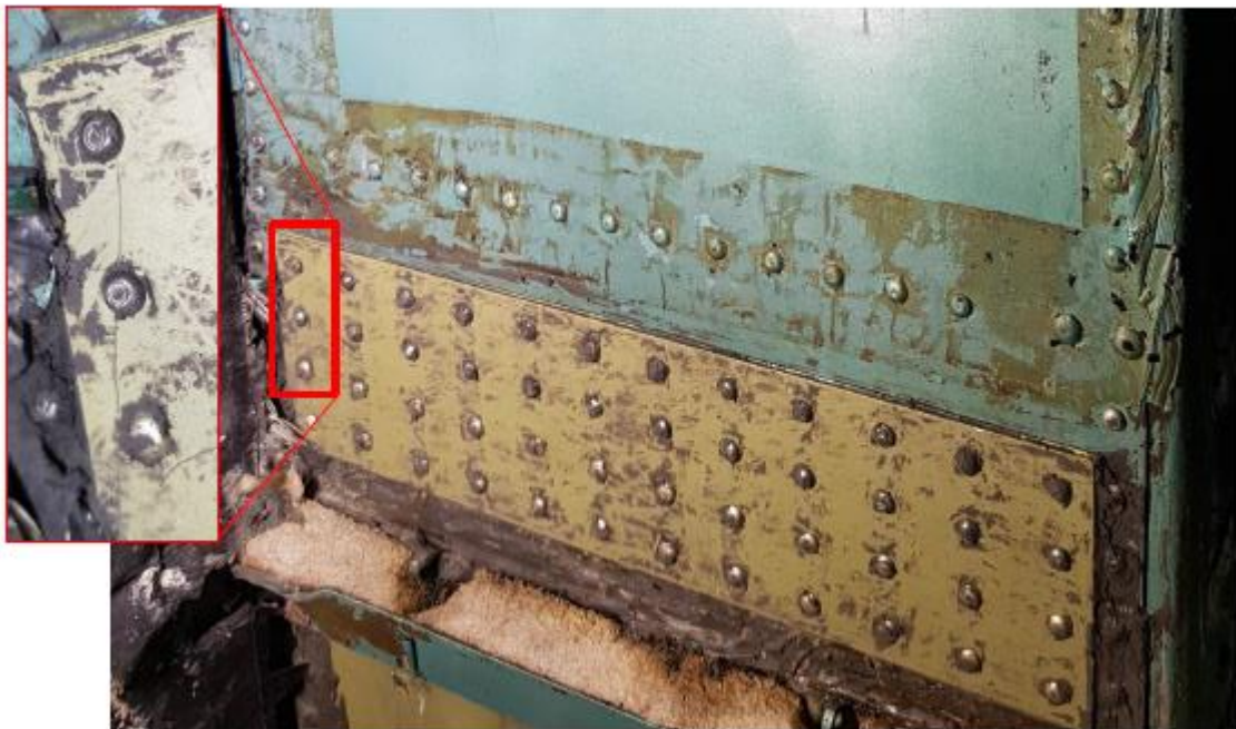
Figura 5.34: Marca superficial aparecida en el refuerzo bajo el sellante. Se repasa con lija y desaparece. (Fuente: Elaboración propia)
