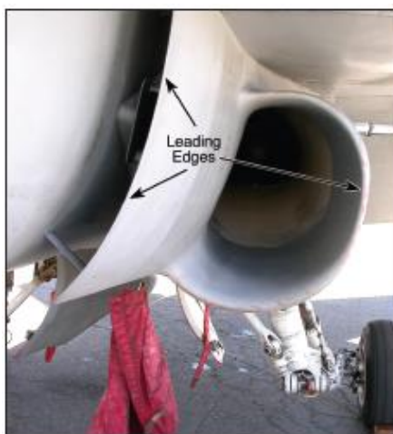
Figura 3.8: Zonas propensas a la corrosión en la admisión de aire del motor de un F18. (Fuente: [10])
