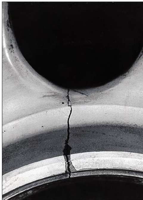
Figura 2.21: Grieta debida a corrosión bajo tensiones. (Fuente: [1])
