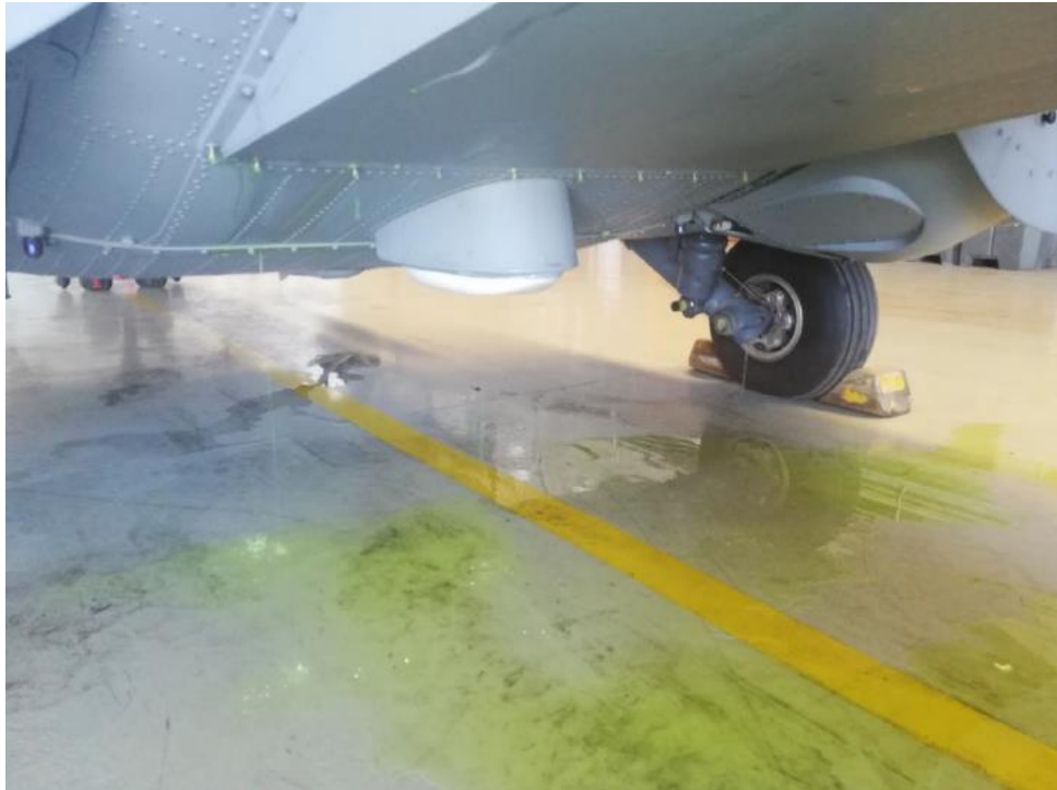
Figura 5.20: Agua cayendo por la estructura del suelo de la cabina de carga. Se observa que pasa a través de las hembrillas de la zona del maletero, por los agujeros de drenaje de los depósitos de combustible y por otras zonas de la estructura. (Fuente: Elaboración propia)
