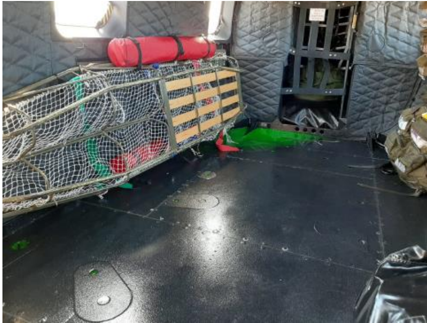
Figura 5.22: Agua estancada en la esquina trasera derecha y en alojamientos de argollas y sujeciones del suelo. (Fuente: Elaboración propia)
