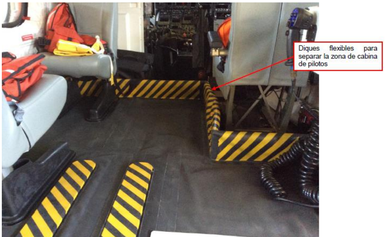
Figura C.6: Diques para separar la cabina de la zona de los pilotos. (Fuente: [29])
