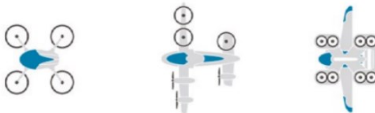
Figura 1.5: Configuraciones multirrotor, tilt-rotor y desacoplada-propulsiva, respectivamente. [2]
