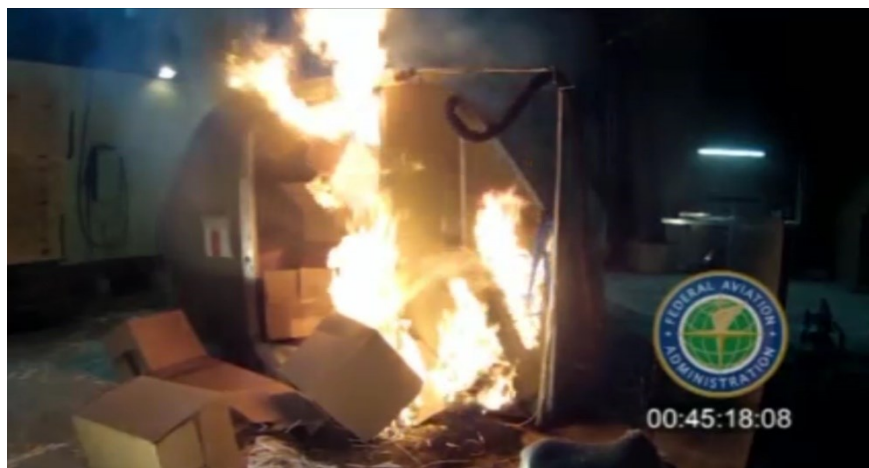
Figura 1.24: Un ejemplo de la violencia de un evento térmico. Este es un fotograma de la grabación de un ensayo de la FAA para comprobar las consecuencias de un evento térmico en un cargamento de baterías de litio en un avión. [45]
