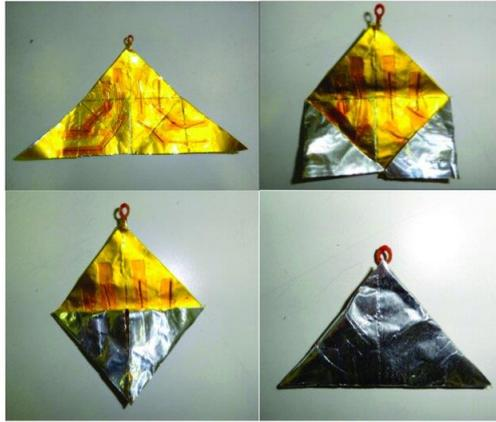
**Figura 9.4** Secuencia de la configuración de plegado de una vela solar autodesplegable.
