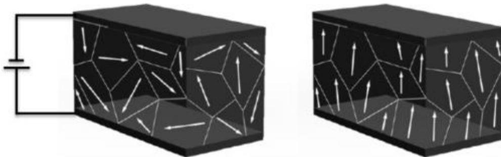
**Figura 1.1** Representación del efecto piezoeléctrico en policristalinos. (Fuente: [14])
