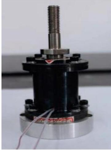
**Figura 3.3** Prototipo fabricado de aislante de vibraciones basado en elastómeros MR.
