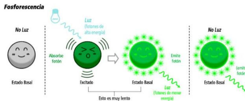
**Figura 5.4** Representación esquemática del fenómeno de fosforescencia. (Fuente: [109])
