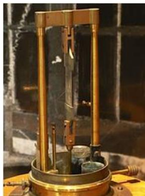
**Figura 1.9** Imagen de un generador piezoeléctrico. (Fuente: [35])
