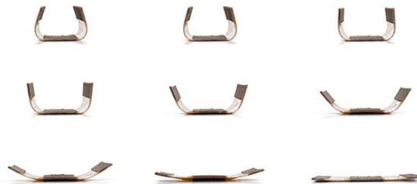
**Figura 8.27** Representación de una madera programable impresa en 4D. (Fuente: [208])
