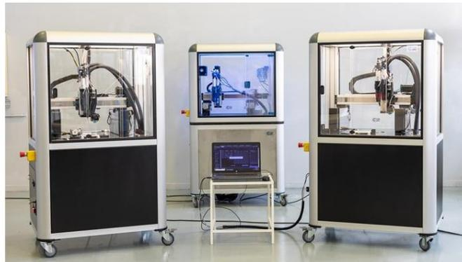
**Figura 8.17** Representación de una impresora basada en la escritura directa de tinta (DIW). (Fuente: [174])
