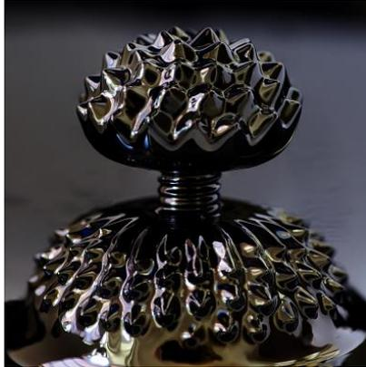
**Figura 3.2** Efecto magnetorreológico en un fluido MR. (Fuente: [57])
