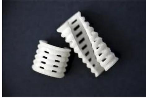
**Figura 8.24** Imagen de una férula impresa en 4D. (Fuente: [199])
