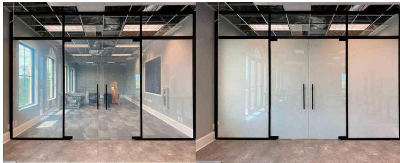
**Figura 4.3** Aplicación de material electrocrómico en ventanas inteligentes. (Fuente: [89])
