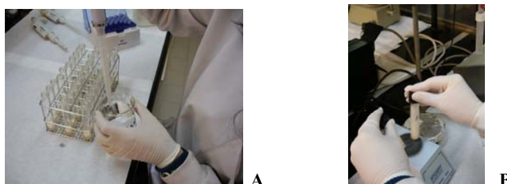
Figura M.1.6. Adición de los reactivos (A); Agitación de la muestra (B).
