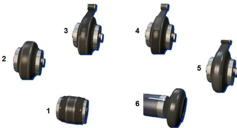
Se da entonces forma al neumático inflando la parte central del tambor. Se colocan dos lonas en la parte superior del neumático, están constituidas por hilos metálicos dispuestos oblicuamente formando triángulos con la línea carcasa para limitar las deformaciones del neumático.
