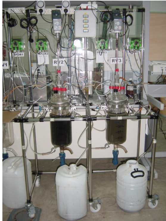
Figura 3.4. Banco de reactores de vidrio
