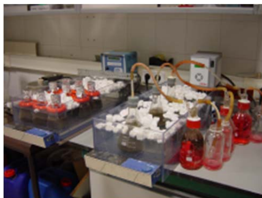
Figura 3.3. Imagen de los reactores del montaje de ensayos en discontinuo.
