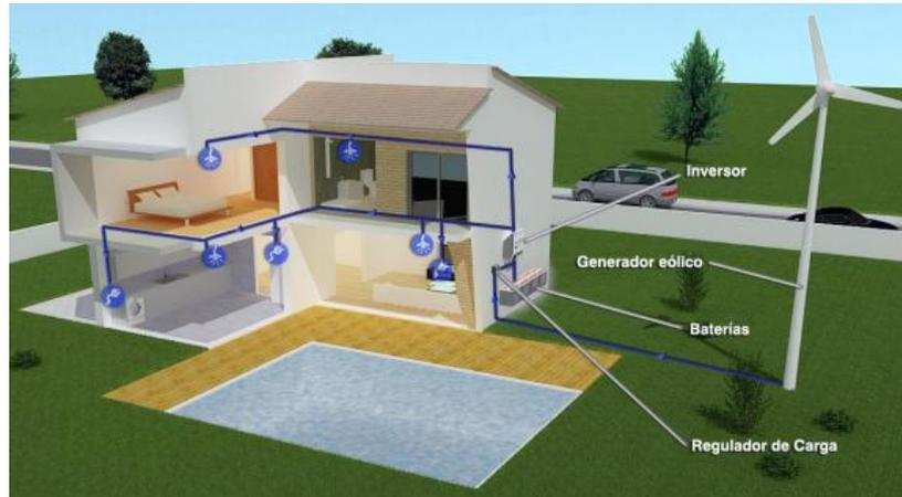
Figura 3.5. Instalación doméstica con aerogenerador. Fuente: [12]
