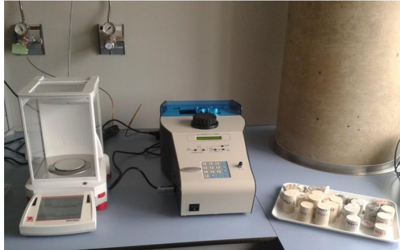
Figura 3.19 Balanza analítica (izquierda), picnómetro de helio (centro) y probetas (derecha)
