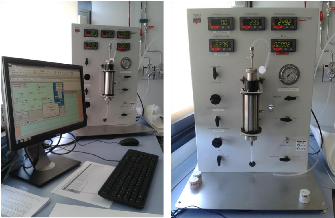
Figura 3.22 Equipo utilizado para la determinación de la permeabilidad de las muestras
