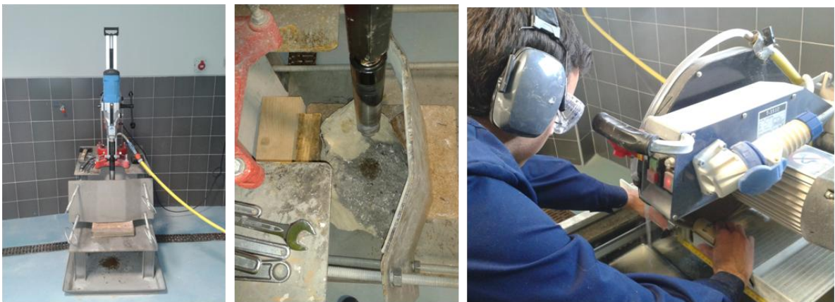
Figura 3.16 Preparación de las muestras: montaje del taladro vertical (izquierda), detalle fijación de la muestra en la base del taladro (centro) y corte en sierra de disco (derecha)
