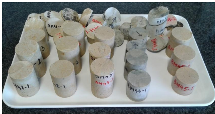
Figura 3.17 Plugs obtenidos tras el proceso de preparación
