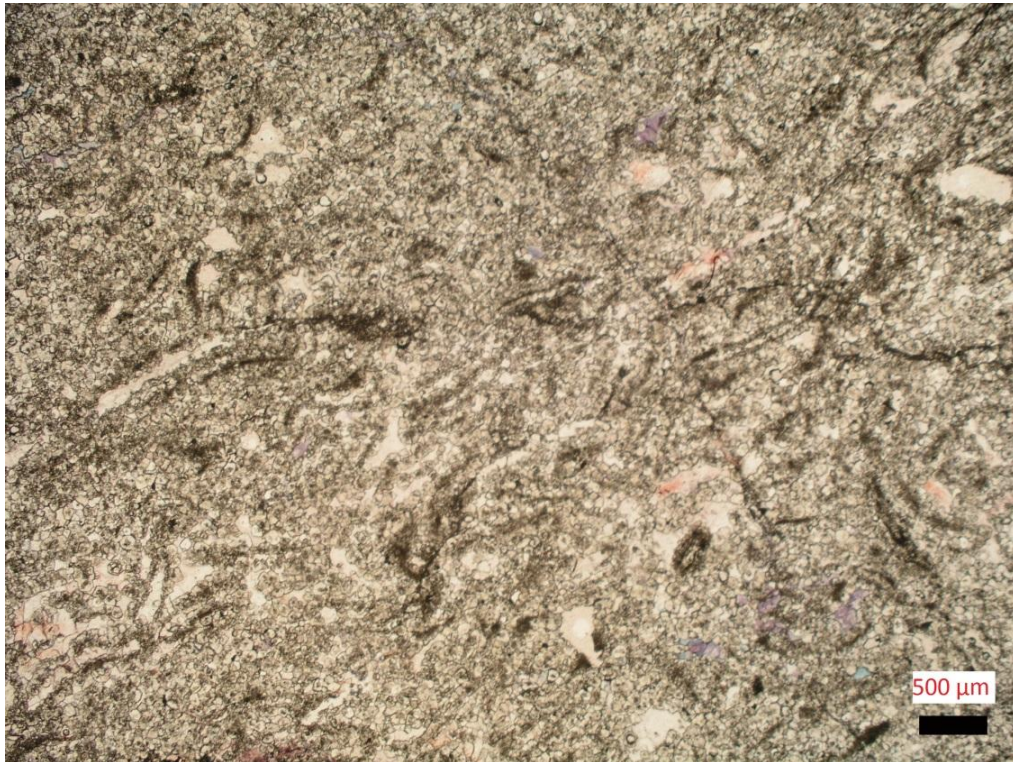
Figura 3.13 Doloesparita en la que se pueden observar frecuentes fantasmas fósiles. Microfotografía de BM4-5 tomada en microscopio óptico, luz natural
