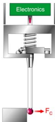
Figura 4-18: Sistema de la sonda electrónica (Fuente: Renishaw)
