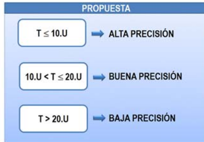
Figura 4-10: Propuesta de evaluación de la precisión necesaria para elementos afectados por tolerancias geométricas y/o dimensionales
