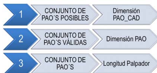
Figura 4-45: Etapas para la determinación de las orientaciones del palpador para cada elemento de inspección
